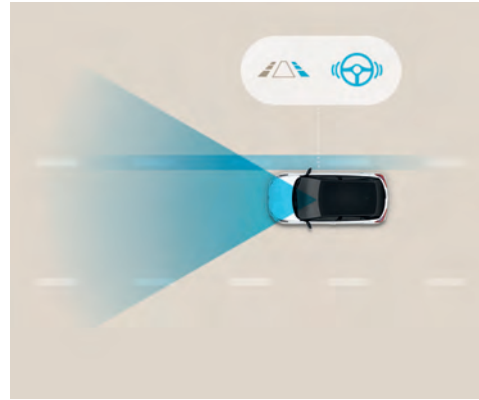
Sistema activo de cambio involuntario de carril (LKA). Este sistema utiliza la cámara frontal para monitorizar las líneas de la calzada. En caso de cambio involuntario de carril, el sistema avisa al conductor e interviene sobre la dirección.
