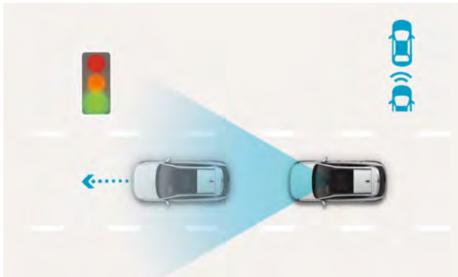
Sistema de alerta de inicio de marcha del vehículo delantero (LVDA). En un entorno urbano, esta inteligente función alerta al conductor cuando el vehículo de delante se pone en marcha en lugares como un semáforo o un atasco.
