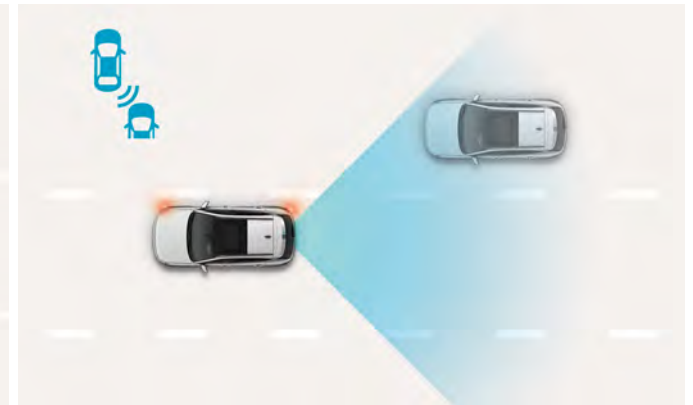
Asistencia de prevención de colisiones en punto ciego (BCA). Este sistema, que ofrece una mayor seguridad en atascos, te avisará y accionará automáticamente los frenos izquierdo o derecho y controlará la dirección cuando intentes cambiar de carril y detecte un vehículo en tu punto ciego.
