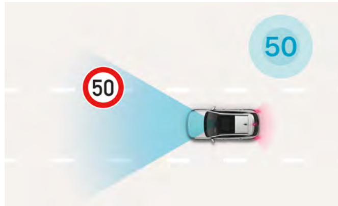
Asistente inteligente de límite de velocidad (ISLA). Este sistema muestra una alerta sonora y visual al exceder el límite de velocidad. Al combinarse con el control de crucero inteligente, puede ajustar la velocidad del vehículo de manera automática.
