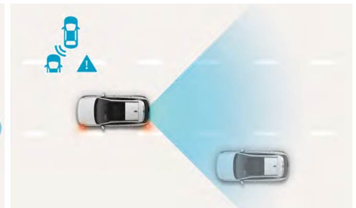
Aviso de prevención de colisiones en punto ciego (BCW). Mediante un radar situado en la parte inferior del parachoques trasero, el sistema te avisa si hay vehículos en tus puntos ciegos. Si pones el intermitente, emitirá una alerta acústica y frenará para evitar una colisión.
