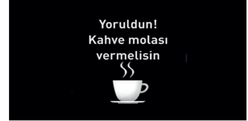
Sürücü Dikkat Uyarısı (DAW) Yorgunluk veya dikkat dağınıklığı tespit edildiğinde, mola verilmesini öneren bir mesaj verir.
