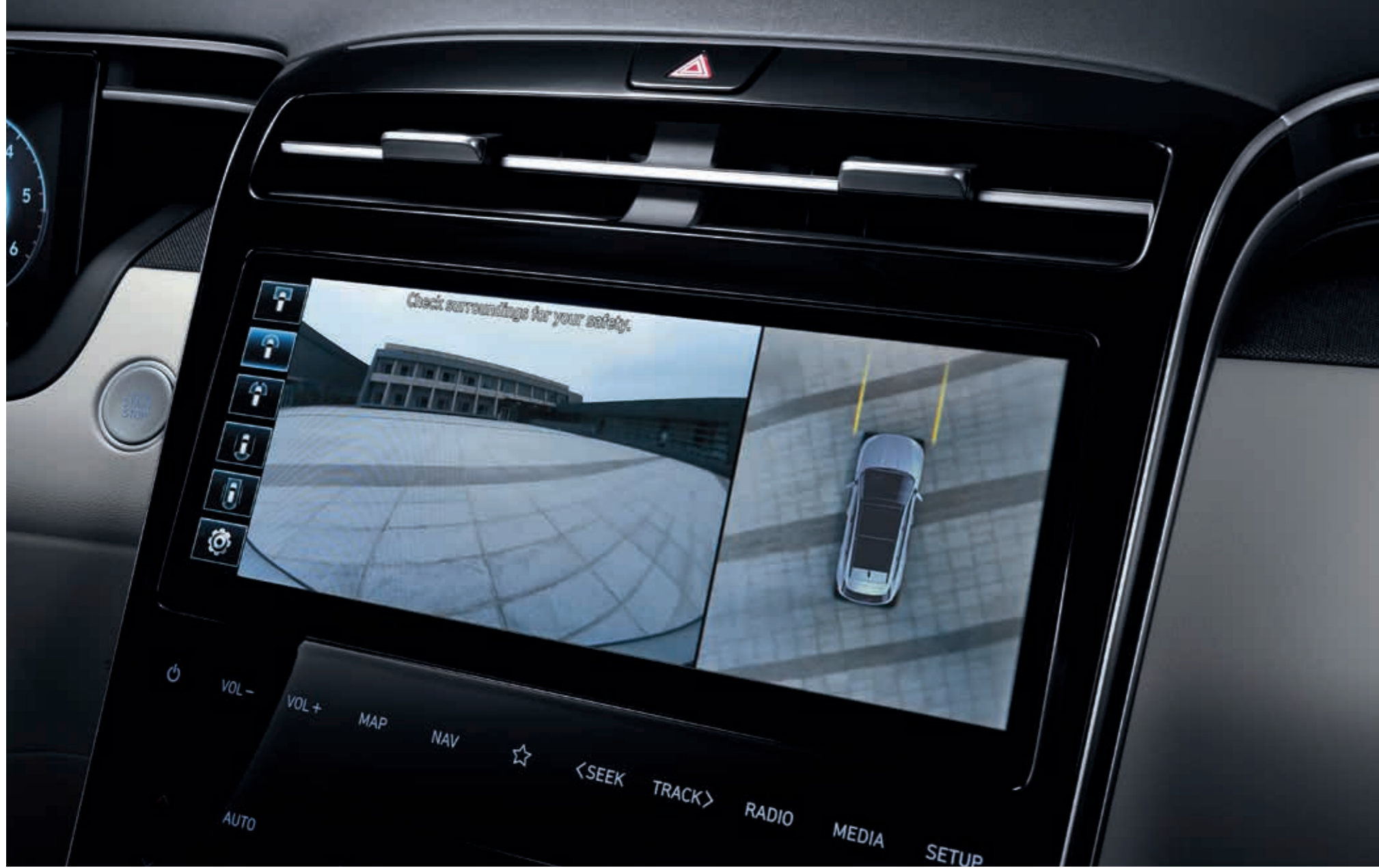
Çevre Görüş Sistemi (SVM) 360° görüş sağlayan bu sistemle daha kolay ve güvenli bir şekilde park edin. TUCSON'un önüne, yanlarına ve arkasına konumlandırılmış dört yüksek çözünürlüklü kameradan aracın çevresini gerçek zamanlı olarak görebilirsiniz.
