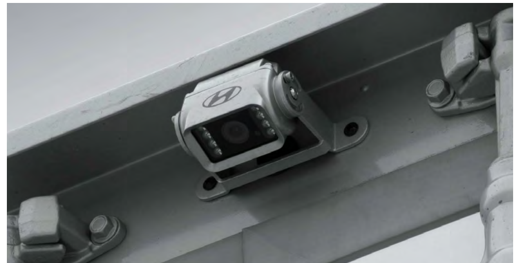
광폭 스트레이트 프레임 적용 후방카메라 (탑차/윈바디/알루미늄카고 기본)
