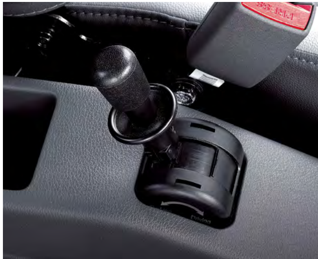
전륜 고하중 액슬(3.7톤) 및 강화 서스펜션 & 속 업소버 그래듀얼 파킹 브레이크
