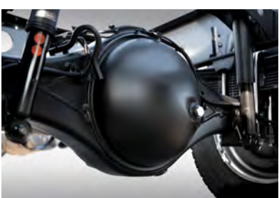
부식 방지용 알루미늄 소재 적용 (크로스 멤버 / 서브 프레임) 고강도 리어액슬 (허용하중 6.6톤)
