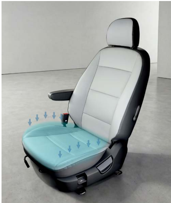
운전석 시트(인조가죽, 고정형, 리클라이닝, 슬라이딩, 에어서스펜션) 도로의 충격과 진동을 최소화 하여 안정적인 승차감을 제공합니다.
