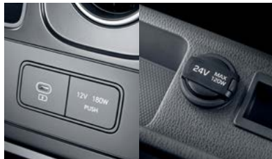
C타입 USB & 12V 파워아웃렛 / 24V 파워아웃렛(센터콘솔 1개, 크래쉬패드 1개)
