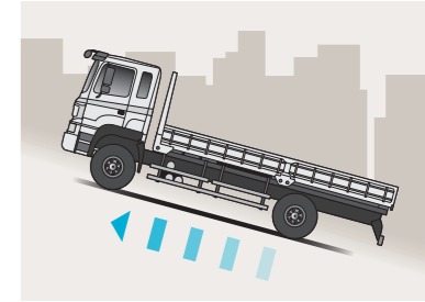
경사로 밀림방지 기능 (6x4 430마력 기본적용) 경사로부터 정지하였다가 차량을 다시 출발 시키려고 할 때 차량이 뒤로 밀리지 않도록 제동압력을 통해 일시적으로 차량을 잡아주어 뒤로 밀림없이 언덕길에서 출발이 가능합니다.
