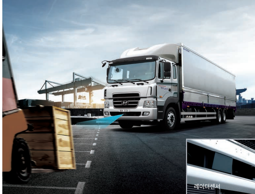
전방 충돌 방지 보조 (4X2/6X4 카고/샤시캡 기본 적용) 긴급한 상황에서 운전자가 브레이크를 밟지 않은 경우, 전방 충돌 위험을 자동으로 판단하고 제동하여 충돌회피 또는 피해를 경감해줍니다.
