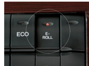
어드밴스드 에코롤 (Advanced Eco-Roll), (자동화변속기 적용시) 내리막길과 평지 탄력주행 거리를 기어 중립 상태로 제어하여 차량의 탄력 주행거리를 증대시켜 연비가 향상됩니다.
