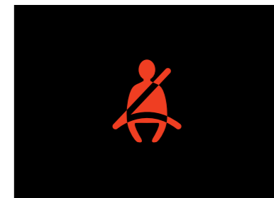
안전벨트 경고 운전석 및 동승석 안전벨트 미착용시 경고등 점멸과 함께 경고음 신호로 탑승자의 안전을 강화합니다.
