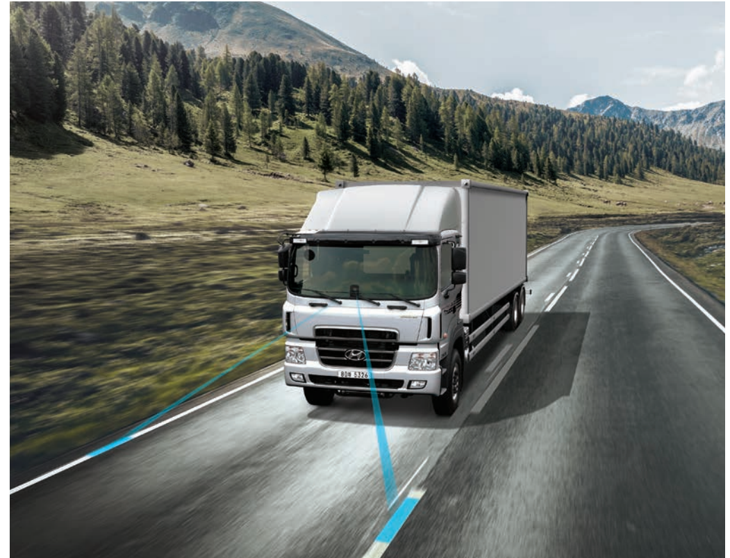
차로 이탈 경고 60km/h 이상 주행시에 차량 전방에 장착된 카메라가 차선을 감지, 턴 시그널 미작동 상태로 차선 변경 및 이탈시 경고를 울려주어 안전운행을 도와줍니다.
