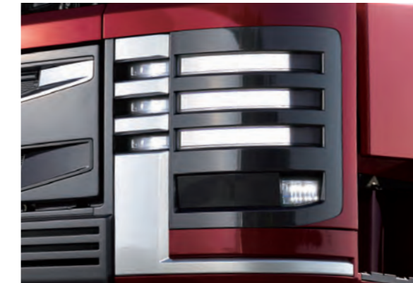
FULL LED 헤드 램프 및 LED 코너램프 프로젝션 타입 LED 로우 / 하이빔 램프를 적용하고, LED 코너램프를 추가하여 야간 시인성에 도움을 줍니다.
