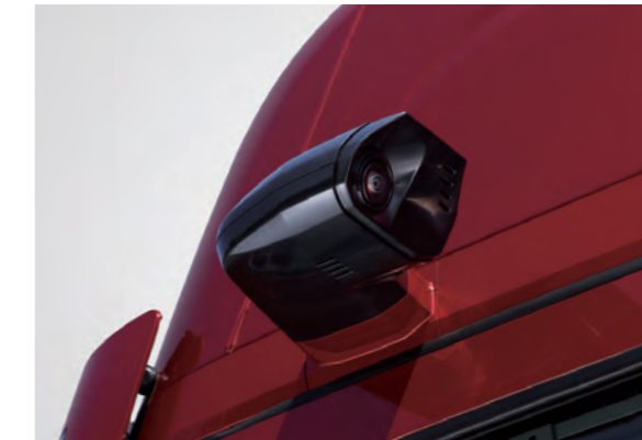
디지털 사이드미러 (외부 카메라) 디지털 사이드 미러 적용으로 공기저항이 줄어 연비 효율을 높이며 운전자의 좌, 우측 시야 개방감을 향상해 주고, 사고 위험을 줄여줍니다.
