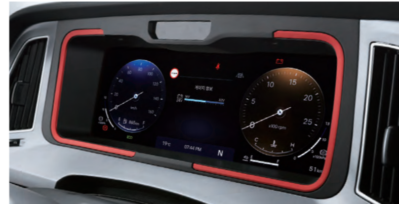
12.3인치 클러스터 / 운전자 전방 주시 경고 카메라 / 베젤 포인트 컬러 12.3인치 LCD 디지털 클러스터와 운전자 전방 주시 경고 카메라, 베젤 포인트 컬러를 적용하여 하이테크한 이미지와 고해상도 화면으로 차량 관련 정보를 얻을 수 있습니다.
