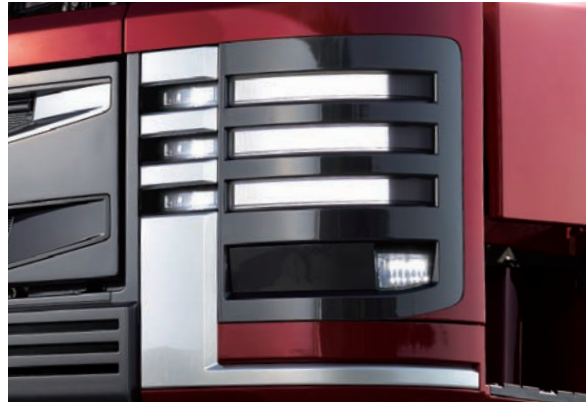
FULL LED 헤드 램프 및 LED 코너링램프 프로젝션 타입 LED 로우 / 하이빔 램프를 적용하고, LED 코너링램프를 추가하여 야간 시인성에 도움을 줍니다.
