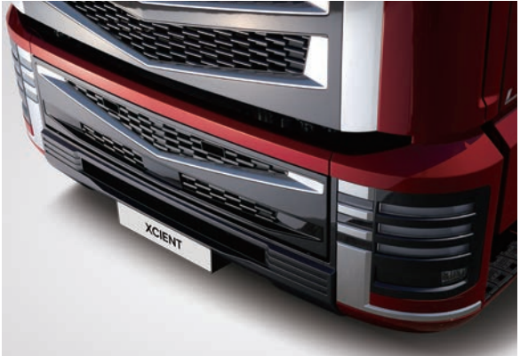
프론트 범퍼 주행 시 또는 정차 및 서행 시 전방충돌방지를 위한 센서가 장착되고 라디에이터 그릴과 일체감을 줍니다.
