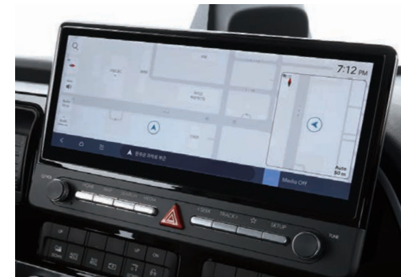
12.3인치 내비게이션 (ccNC) 12.3인치 대화면 고해상도 LCD 디지털 디스플레이를 적용하여 차세대 인포테인먼트 시스템 등 다양한 콘텐츠를 제공합니다.
