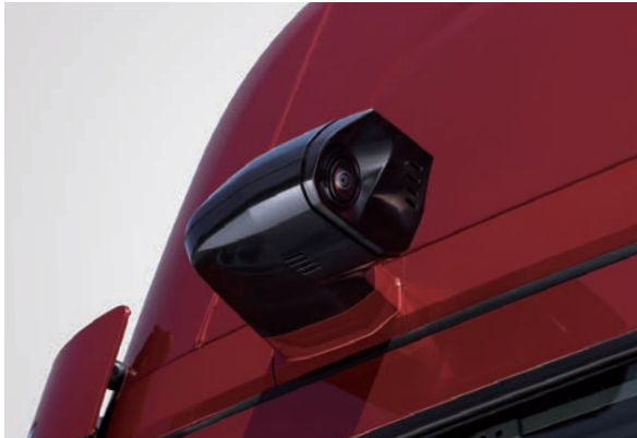
디지털 사이드미러 (외부 카메라) 디지털 사이드 미러 적용으로 공기저항이 줄어 연비 효율을 높이며 운전자의 좌, 우측 시야 개방감을 향상해 주고, 사고 위험을 줄여줍니다.
