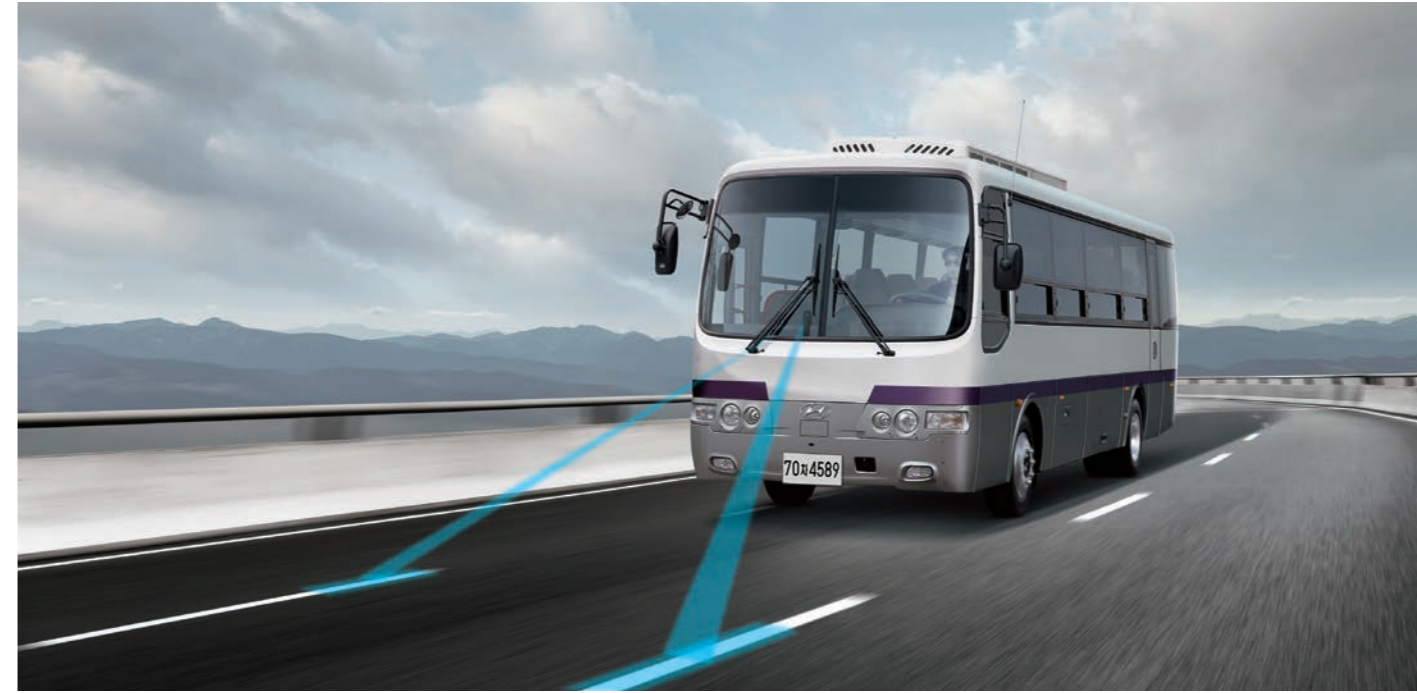
차로 이탈 경고 (전세/자가 기본) 전방 카메라를 이용하여 차량 주행 중 줄을 등으로 차선 이탈 발생 시 운전자에게 시그널을 경고하고 전달합니다.
