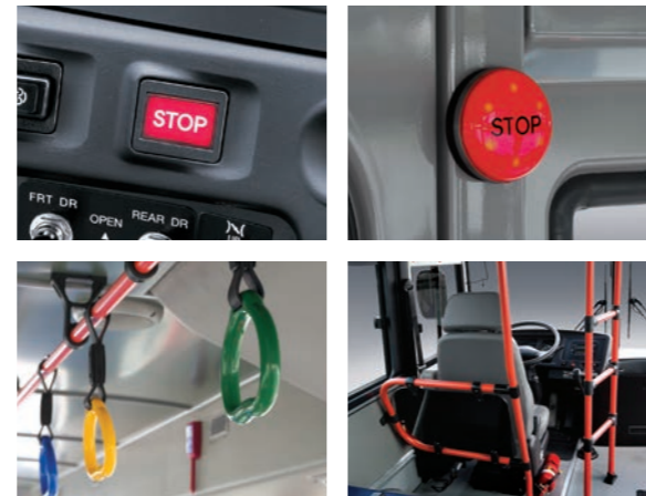
운전석 정차표시등 커버 적용 칼라 핸드레일링 LED 타입 콜부저 운전석 보호막 및 스텐션 파이프
