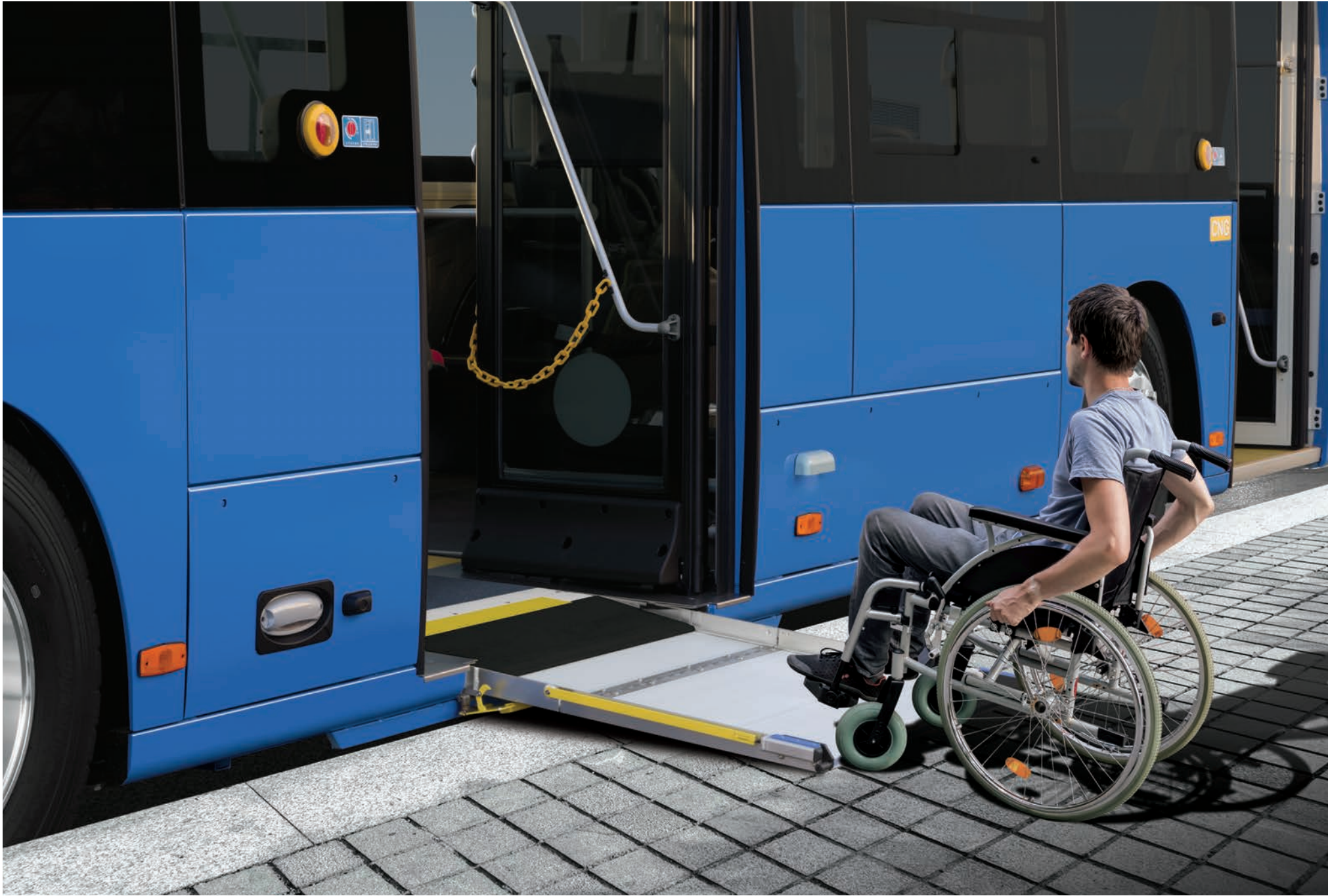
중문 휠체어 탑승장치 휠체어를 이용하는 장애인이 단독으로 손쉽게 승하차 할 수 있도록 하였습니다.
