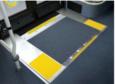
닐링 및 휠체어 탑승장치 작동 스위치 미끄럼 방지패드(중간문) 및 안전선
