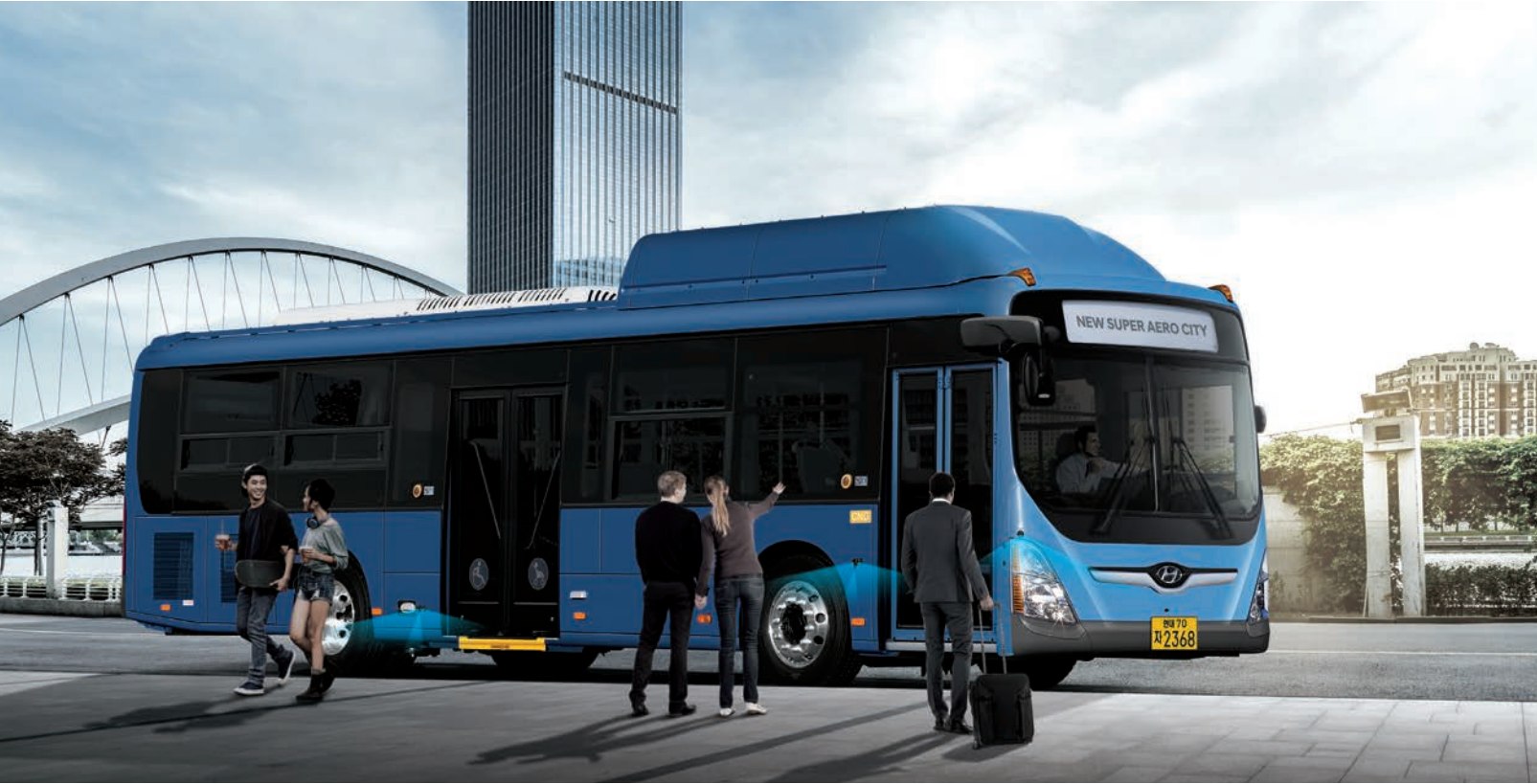
안전하차 경고 (전중문 초음파센서) 전문과 중문에 초음파 센서를 설치하여 승객의 승, 하차시 안전사고를 예방 합니다.
