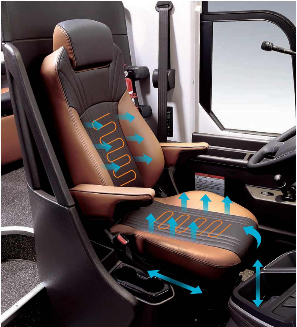
운전석 시트 (멀티펄선 시트, 천연가죽+통풍+열선) 상기 기능 포함 및 전동 팬을 이용하여 덕트를 통해 항균 처리 기능의 시트 쿠션과 등받이에 바람을 보내주어 시트 바닥과 등에 습기가 차는 것을 방지함으로써 쾌적한 착좌감을 제공합니다.
