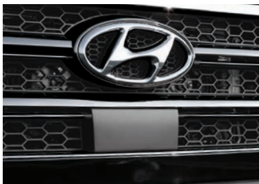
전방 카메라 (전방 충돌방지 보조/ 차로 이탈 경고) 전방 레이더(전방 충돌방지 보조)
