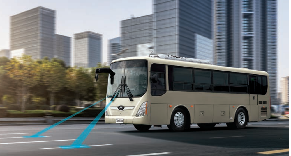
차로이탈 경고 (시내좌석/자가용/시외직행 기본장착) 전방 카메라를 이용하여 차량 주행 중 줄을 등으로 차선 이탈 발생 시 운전자에게 시그널을 경고하고 전달합니다.
