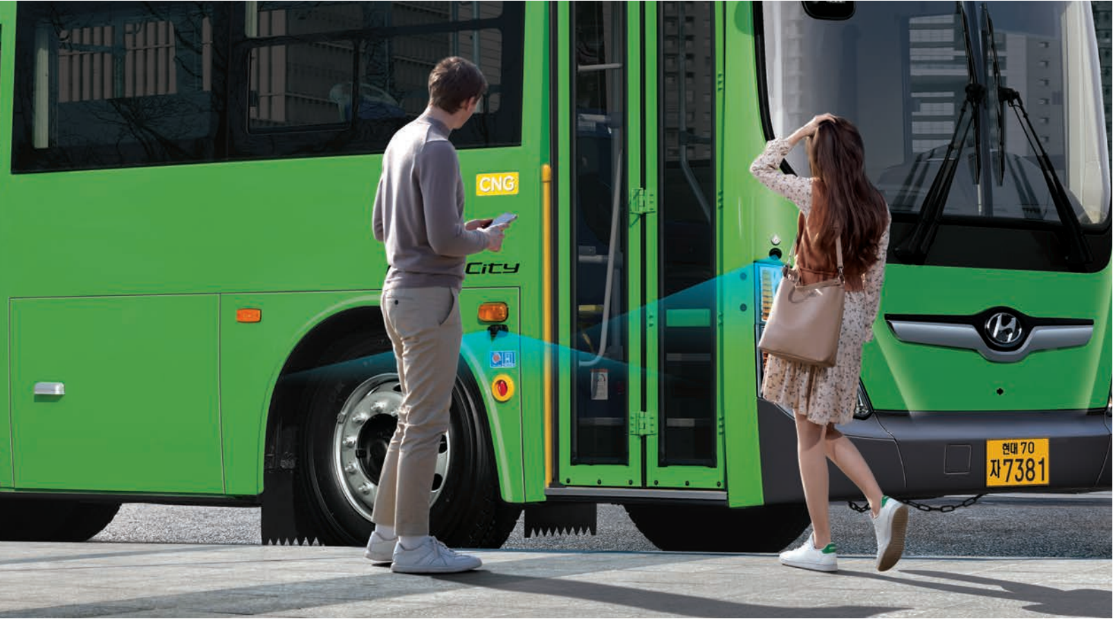
안전하차 경고 (전중문 초음파센서) 전문과 중문에 초음파 센서를 설치하여 승객의 승, 하차시 안전사고를 예방 합니다.
