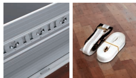
POSMAC 재질이 적용된 적재함 내부 E-트랙 (좌, 우 각 1열) & 벨트 (17개)
