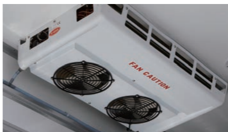
더블 냉동기 (4+2 FAN)
