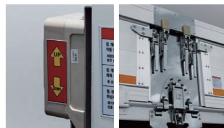
윙 개폐 조작 스위치 & 스테인리스 센터 포스트
