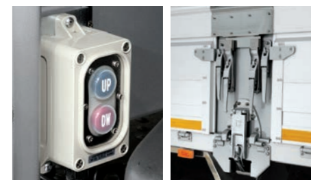
윙 개폐 조작 스위치 & 스테인리스 센터 포스트
