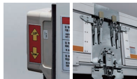
윙 개폐 조작 스위치 & 스테인리스 센터 포스트
