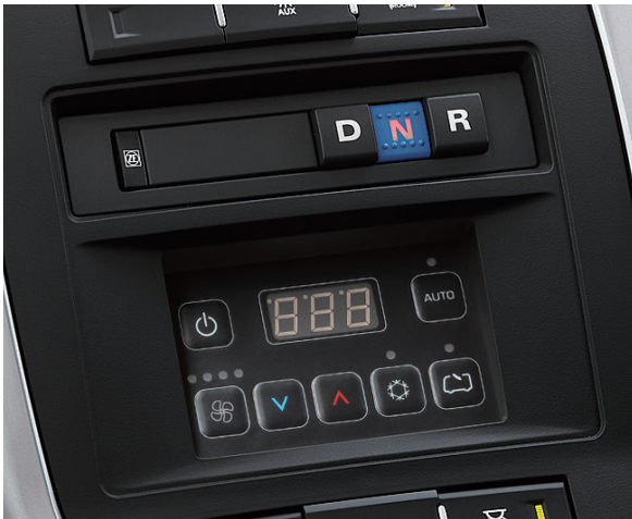
안전한 주행을 위한 다양한 정보가 탑재된 LCD 클러스터 버튼형 전자식 자동 변속기 / 전자식 에어컨 컨트롤러
