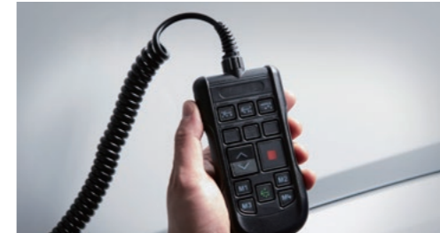
ECAS 스위치 전자 제어 에어 서스펜션(ECAS)을 제어함으로써 화물 적재로 인하여 변화된 차량 자세를 안정적으로 조절할 수 있습니다.
