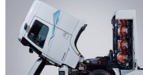
전동식 캡 틸팅 엔진 및 주요 부품에 쉽게 접근할 수 있는 전동식 캡 틸팅 시스템을 적용해 차량 운휴 시간을 줄여 줍니다.
