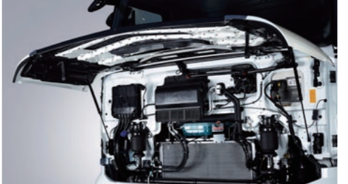
프론트 정비 판넬 프론트 판넬 열림 각도를 증대하고, 보조 스트랩을 추가하여 정비 및 작업 편의를 높였습니다.
