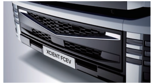
프론트 범퍼 전방 충돌 방지 센서를 매립함으로써 라디에이터 그릴과의 일체감을 유지하는 한편 우수한 기능성을 확보했습니다.
