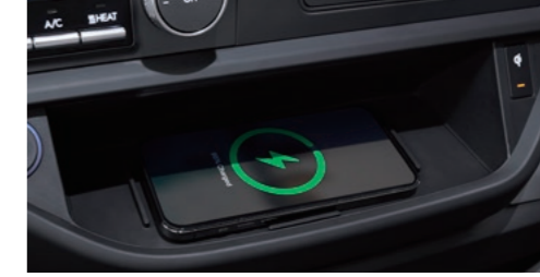
스마트폰 무선 충전 (10W) 스마트폰 과열 방지를 위해 안전 기능을 적용했으며, 10W의 넉넉한 출력으로 충전 시간을 단축했습니다.
