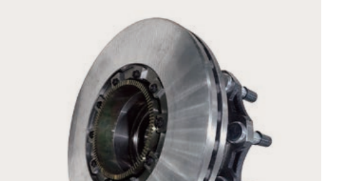
슬라이딩 타입 디스크 브레이크 내구성과 정비성이 우수한 슬라이딩 타입 디스크 브레이크를 적용하여 브레이크 로터의 교환 주기를 증대했습니다.
