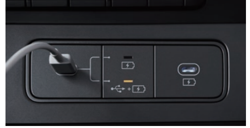
C 타입 USB 단자 및 충전 포트 충전 성능이 우수한 C형 USB 포트를 적용하여 스마트 기기 충전, 미디어 재생, 콘텐츠 이용 등이 모두 가능합니다.
