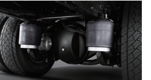
전후측 에어 서스펜션 노면 상태, 차량 하중 등에 따라 충격을 효과적으로 흡수해 운전자 피로뿐만 아니라 화물 손상도 최소화합니다.
