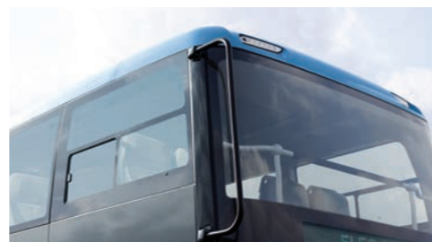
프로텍터바 (2층 전면 글라스 충격 및 파손 방지)
