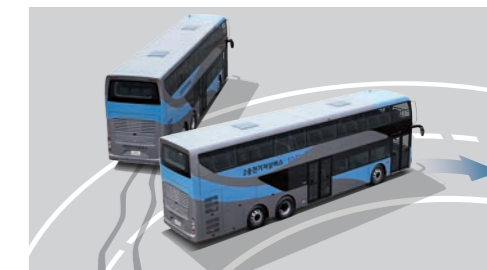
차체자세 제어기능 (VDC) 출력 및 브레이크를 제어하여 차량자세 안정성 향상
