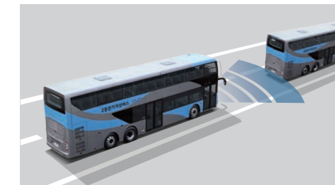
전방 충돌 방지 보조 전방 충돌 위험 알림 또는 제동으로 사고 위험 최소화
