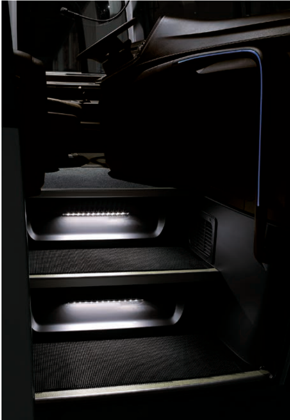
발광타입 탑승구 그립바 및 LED 스텝 램프 탑승구에 발광타입 그립바와 스텝 LED 램프를 적용하여 야간 시 안전한 승, 하차를 할 수 있습니다.
