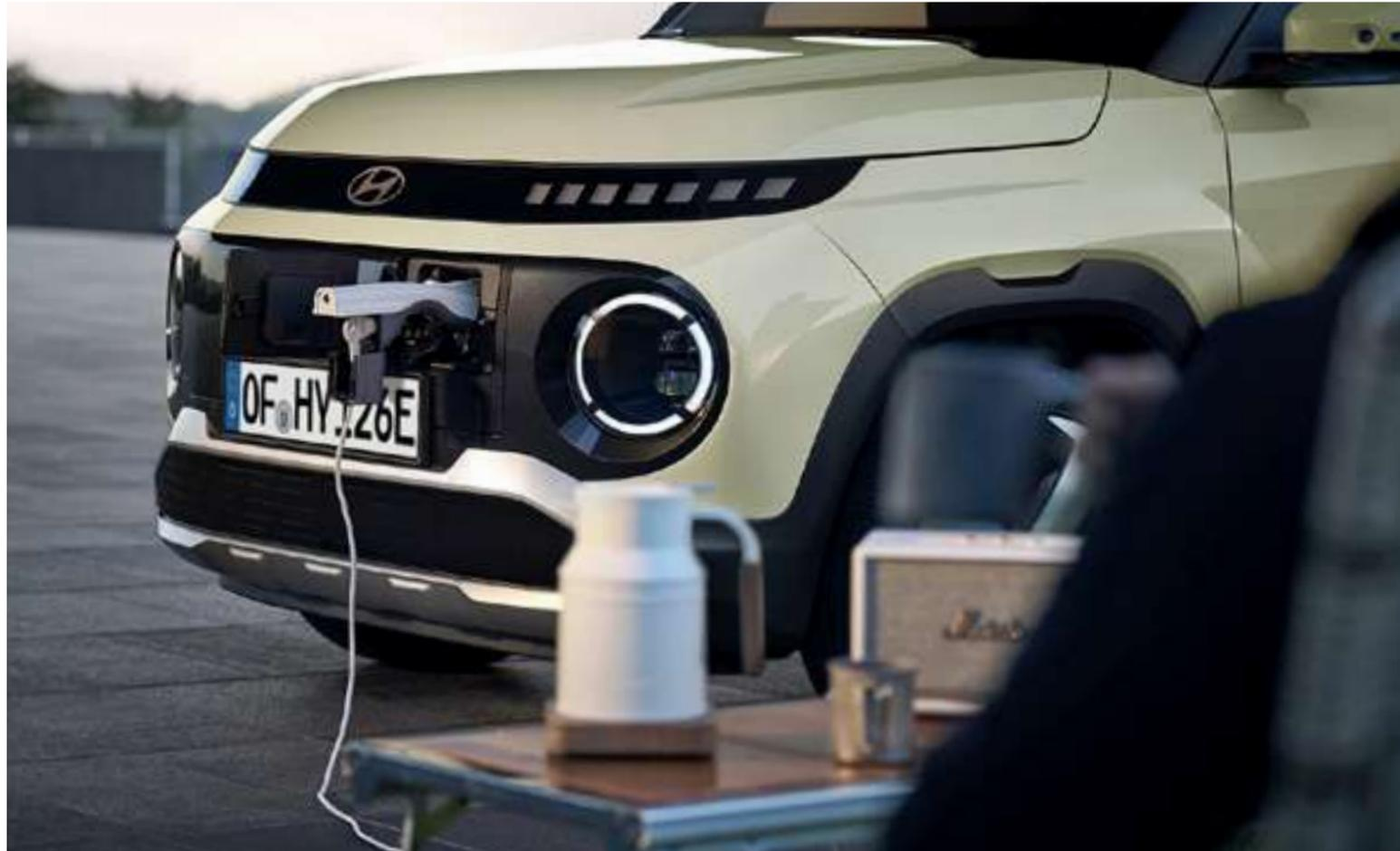
Solo tienes que enchufar tu portátil o la bicicleta eléctrica para cargarlos, como lo harías en casa. Hay una toma de 220 V situada en la consola central, además de un transformador que se conecta en el puerto de carga exterior que suministra una potencia de 3,6 kW, incluso cuando el vehículo está apagado.
