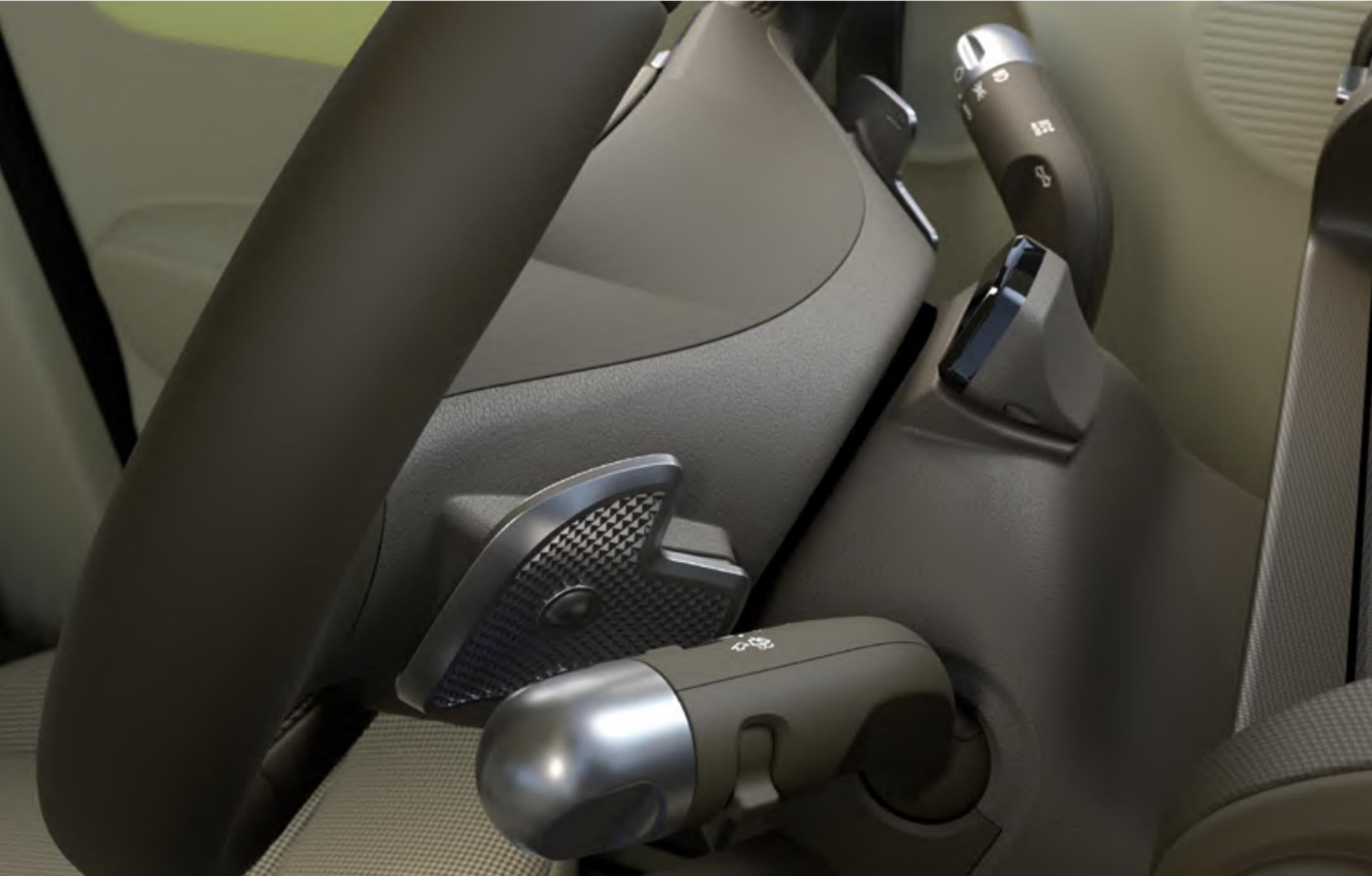
El sistema de frenado regenerativo 2.0 del INSTER carga la batería usando el motor eléctrico para disminuir la velocidad. Puedes controlar el nivel de energía que el sistema regenera y almacena en la batería ajustando el nivel de frenado regenerativo con las levas de cambio montadas en el volante.
