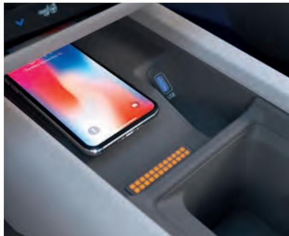
El puerto de carga inalámbrico de alta velocidad incorpora píxeles paramétricos con los que puedes ver el nivel de carga de tu smartphone al instante.
