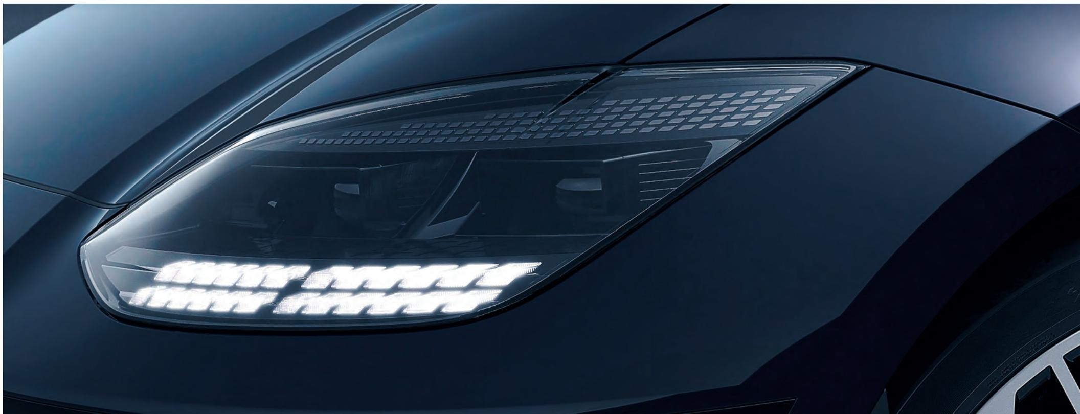
El sistema de iluminación delantera inteligente, que incorpora tecnología LED matricial y luces de circulación diurna de píxeles paramétricos, se adapta automáticamente a las condiciones de la carretera, maximizando el uso de las luces largas sin peligro de deslumbrar a los conductores que circulan en sentido contrario.
