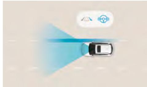
**Sistema activo de cambio involuntario de carril (LKA).** El LKA estándar utiliza la cámara frontal para controlar las líneas de la carretera. En caso de una salida no planeada del carril, avisará al conductor y puede aplicar el par de contra-volante para guiar el coche de vuelta al carril.
