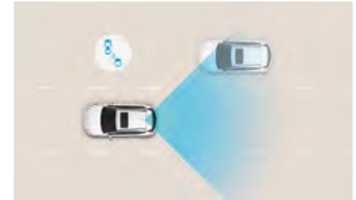
**Sistema de alerta de detección de ángulo muerto (BSCW) con ayuda al cambio de carril (LCA).** El sistema te advierte de forma visual del tráfico en la zona del ángulo muerto con 2 sensores de radar situados en el parachoques trasero. Si utilizas el intermitente en ese momento, el sistema de aviso de cambio de carril producirá una alerta acústica.
