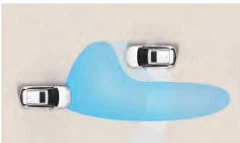
**Tecnología de iluminación Full LED.** Las luces de carretera automáticas detectan los vehículos que se aproximan, así como los vehículos en el mismo carril por delante de noche, y cambia de luces de carretera a luces de cruce según sea apropiado. La Luz de giro ilumina las partes laterales delanteras cuando se toman curvas, mejorando la visibilidad nocturna.
