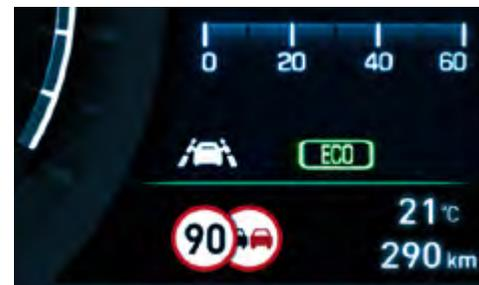
**Sistema de reconocimiento de señales (ISLW).** El sistema de alerta inteligente de límite de velocidad utiliza la cámara frontal y la información del sistema de navegación para identificar las señales y mostrártelas en tiempo real. La información aparece tanto en la pantalla del sistema de navegación como en el TFT del cuadro de instrumentos.
