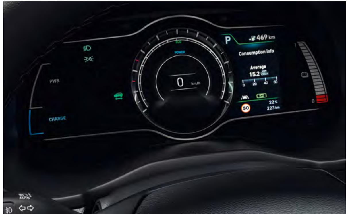
**Nuevo panel de instrumentos de 7":** el innovador panel de instrumentos digital de 7" indica el modo de conducción y registra con toda claridad tanto el flujo eléctrico como el nivel de carga de la batería. Basta con un rápido vistazo para saber cómo influye tu modo de conducir en la autonomía.
