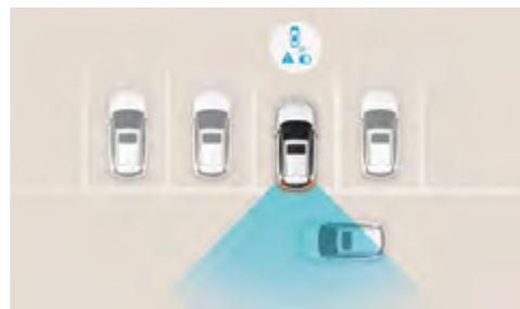
**Sistema de aviso de colisión trasera (RCCW).** Al salir de una plaza de aparcamiento estrecha, el sistema de aviso de colisión trasera reduce el riesgo de colisión. Con los 2 sensores de radar traseros, te avisa en caso de que algo se aproxime a la parte trasera.
