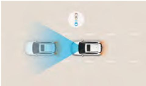
**Sistema de asistencia a la frenada de emergencia con detección de peatones (FCA).** El sistema FCA utiliza la cámara frontal y el sensor de radar para supervisar el tráfico por delante. Si detecta una posible colisión con un vehículo por delante o con un peatón advertirá al conductor y, si es necesario, ralentizará o detendrá el vehículo automáticamente.
