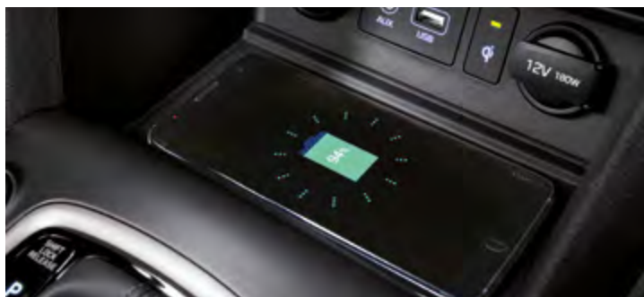
Cargador de teléfono inalámbrico: Ubicado en la consola central, un cargador inalámbrico (estándar Qi) te permite cargar fácilmente un smartphone compatible con Qi sin tener que usar cables enmarañados y antiestéticos.
