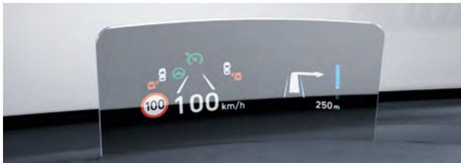
Head-up display (HUD): Con una iluminación de primera clase para una fácil visibilidad, nuestro nuevo head-up display te ayuda a mantenerte seguro proyectando información importante como la velocidad, comandos de navegación y avisos en tu línea de visión.
