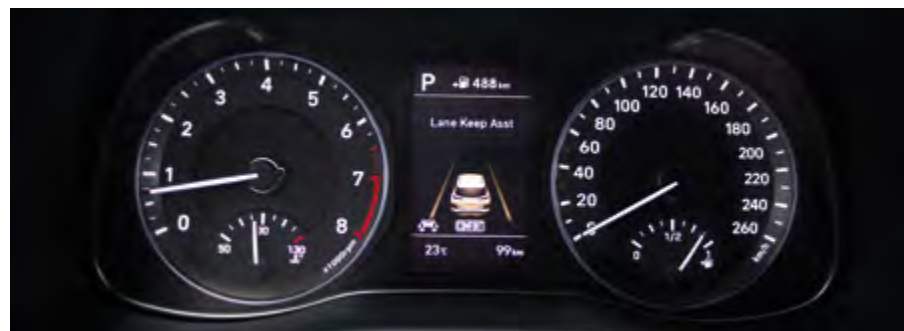
Ordenador de a bordo: Colocado de forma óptima y fácil de leer, una pantalla LCD de 4,2" te muestra información importante para el conductor, como el estado de las características de seguridad activas, la autonomía restante, el consumo de combustible, instrucciones de navegación y la temperatura exterior, entre otras.
