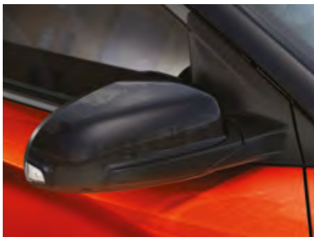
Retrovisores exteriores con indicador LED.
