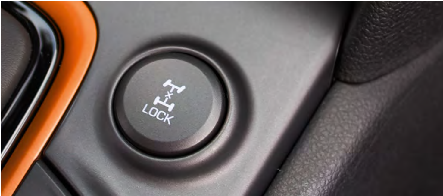
Tracción a las cuatro ruedas a demanda. Disponible con motor 1.6 T-GDi 130kW (177 CV).
