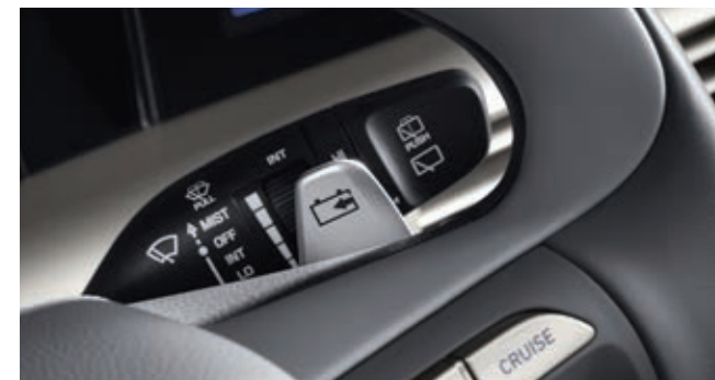
Levas para control de frenada regenerativa (control de la frenada de recuperación)
