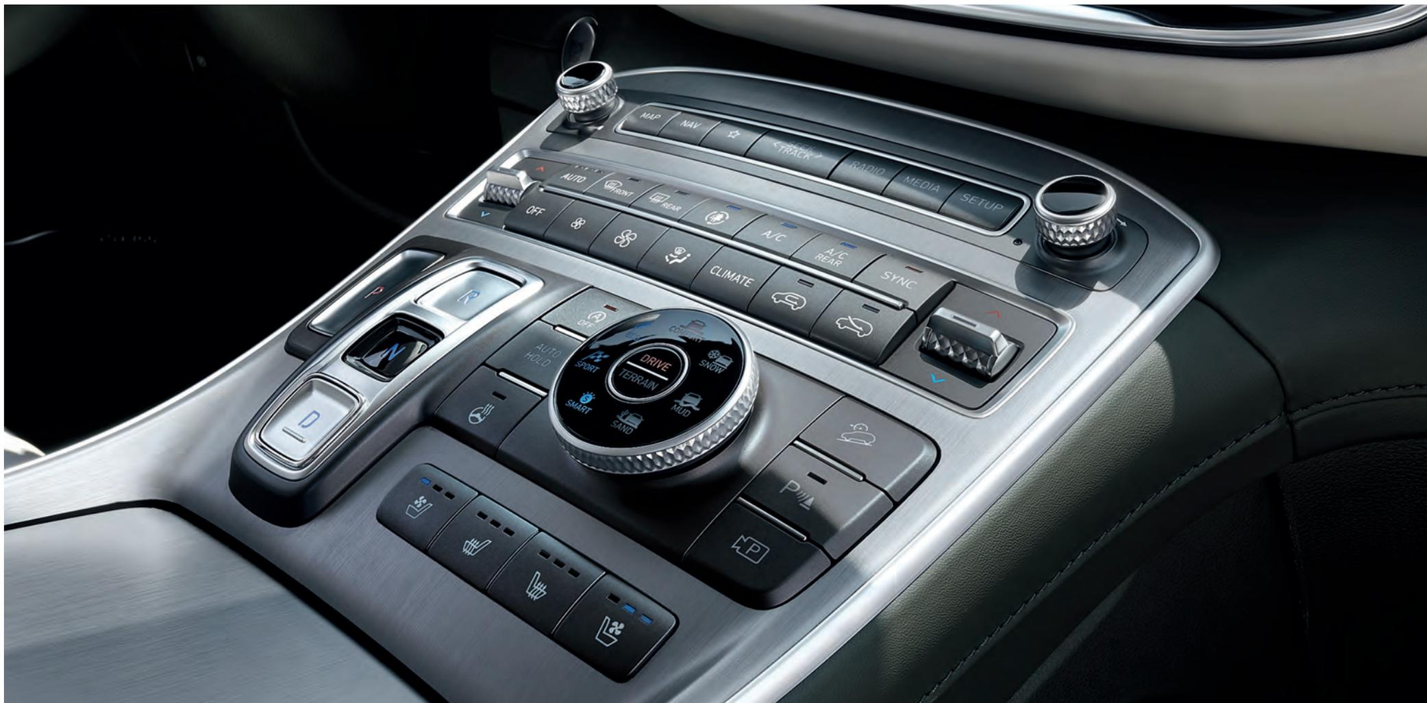
Consola central tipo puente y cambio automático por botones (Shift by Wire)
