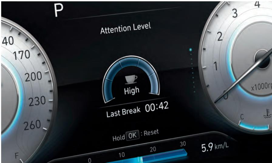
Detector de atención del conductor
