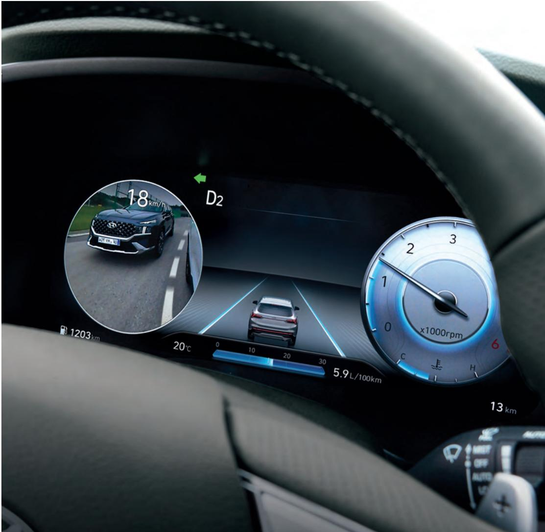
Panel de instrumentos digital de LCD de 12,3" y monitor de visualización de ángulos muertos
