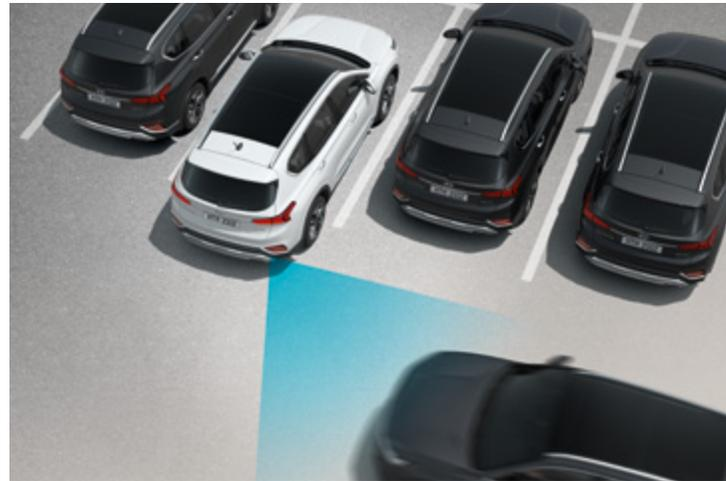
**Advertencia de colisión frontal tráfico cruzado (RCCW).** Los sensores dispuestos en el parachoques trasero alertan al conductor sobre vehículos que se puedan cruzar desde el lado izquierdo y derecho del vehículo durante las maniobras de marcha atrás.
