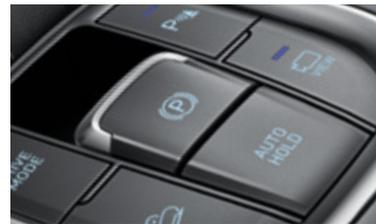
Sistema de freno de estacionamiento eléctrico (EPB)
