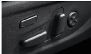
Asiento del conductor con ajuste eléctrico de 14 posiciones
