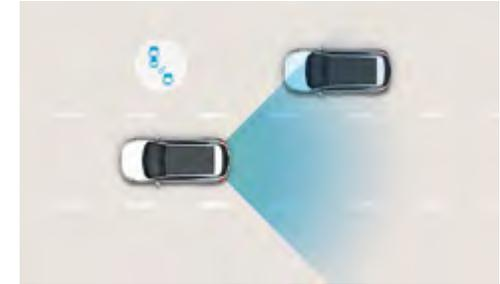
**Sistema de aviso de ángulo muerto (BSD) con asistencia de cambio de carril (LCA):** Usando 2 sensores de radar en la parte trasera inferior parachoques, el sistema te advierte visualmente del tráfico en las áreas de ángulo muerto. Si accionas cualquiera de los indicadores en tal situación, el Asistente de Cambio de Carril (LCA) hará sonar una alerta acústica.
