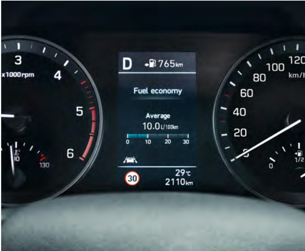
**Panel de supervisión:** Ubicado de manera óptima y fácil de leer, el panel de supervisión con su pantalla LCD a color de 4.2" muestra información importante para el conductor, como el estado de las funciones de seguridad, la autonomía del vehículo, consumo de combustible, instrucciones de navegación, temperatura exterior y mucho más.
