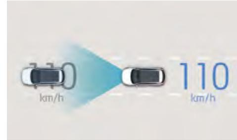
**Control avanzado de cruceo adaptativo con Stop & Go (ASCC):** Usando sensores de radar frontales, el Control avanzado de cruceo adaptativo con Stop & Go (ASCC) mantiene una velocidad y una distancia constantes con el vehículo que tiene delante, acelerando y frenando automáticamente. Si el tráfico se detiene, el sistema Stop & Go aplica el freno hasta que el automóvil se detiene y acelera a la velocidad deseada tan pronto como la carretera esté despejada.
