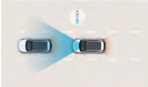
**Asistente de colisión frontal (FCA):** Un sistema compuesto por una cámara frontal y un radar actúan para escanear el camino detectando vehículos precedentes y peatones. En caso de detectar la posibilidad de colisión, el FCA emite una señal de alarma y automáticamente frena o para el vehículo.
