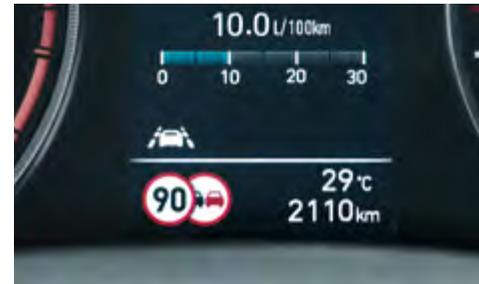
**Aviso inteligente de límite de velocidad (ISLW):** El limitador de velocidad inteligente utiliza la cámara frontal y la información del sistema de navegación para identificar señales de velocidad en la carretera, y muestra el límite de velocidad y las señales de no rebasar en tiempo real. La información se muestra tanto en la pantalla del sistema de navegación como en la pantalla TFT.
