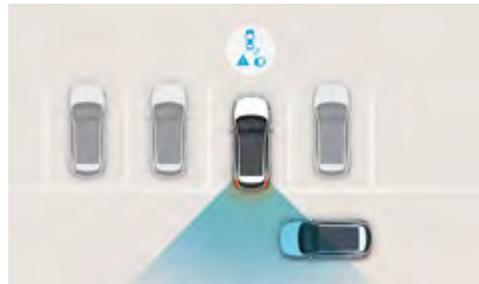
**Asistente contra colisiones traseras (RCCA):** Al dar marcha atrás en un espacio de estacionamiento pequeño, la Advertencia de Colisión Trasera reduce el riesgo de una colisión. Usando 2 sensores en la parte trasera, te avisa en caso de que se aproxime el tráfico.
