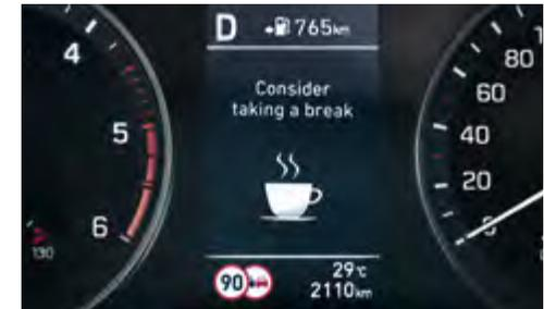
**Sistema de detección de fatiga del conductor (DAW):** Este dispositivo aumenta la seguridad y la comodidad a un nivel completamente nuevo al monitorear y analizar continuamente los patrones de conducción. Cuando se identifica un patrón de fatiga o distracción, DAW avisa al conductor con una alerta sonora y un mensaje en el panel de instrumentos que le sugiere un descanso.
