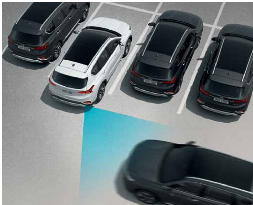
Advertencia de colisión frontal tráfico cruzado (Rear Cross-Traffic Collision Warning, RCCW)
