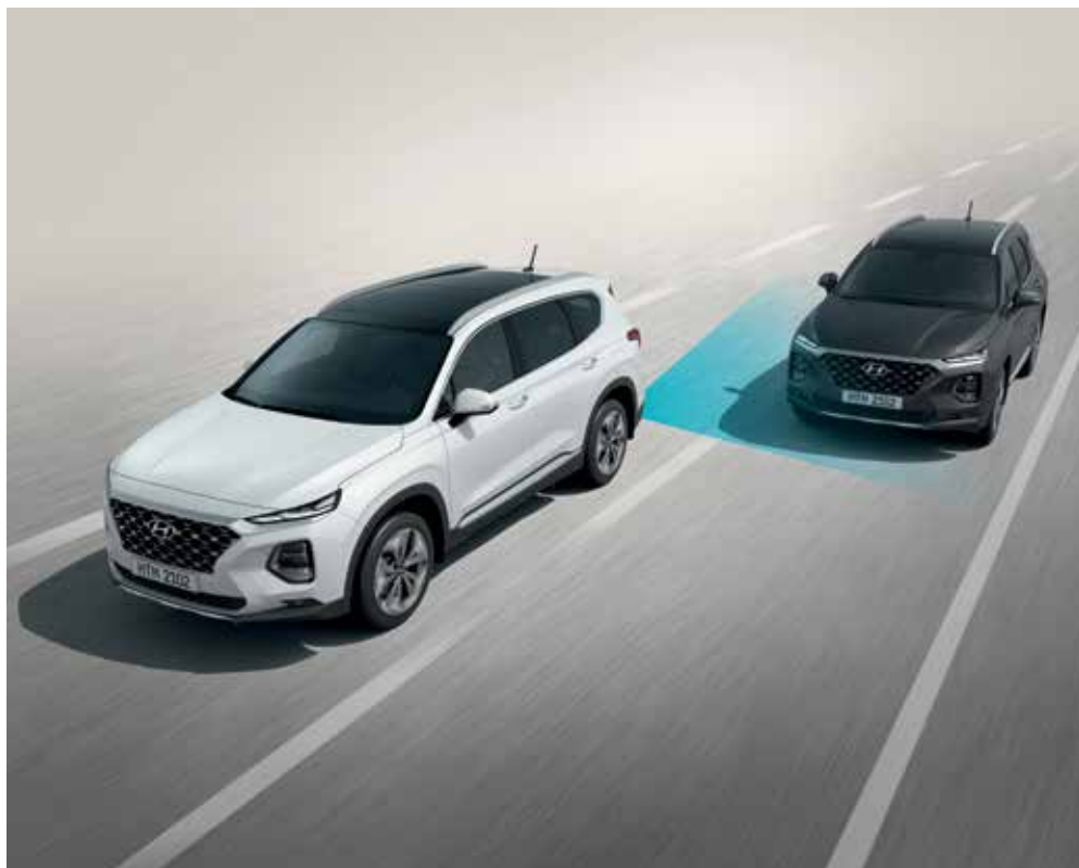
Advertencia de colisión de punto ciego (Blind-Spot Collision Warning, BCW)
