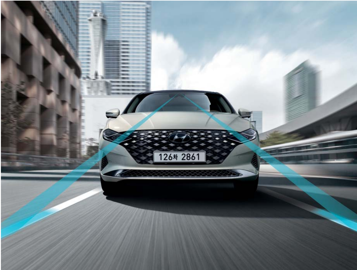
차로 유지 보조 전방 카메라를 이용해 차선을 인식하고 차선의 가운데로 차량이 주행할 수 있도록 도와줍니다. 필요시 자동으로 스티어링 휠을 제어하여 기존 주행 차로를 유지할 수 있게 도와줍니다.
