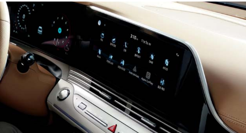
12.3인치 Full LCD 클러스터 컬러 LCD 클러스터(1,920x720)는 시인성이 높고 정보 파악이 용이하며, 주행모드별 차별화된 그래픽으로 즐거운 드라이빙 환경을 제공합니다.
