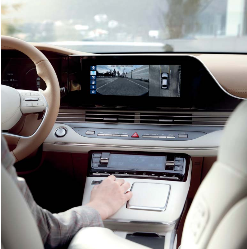
서라운드 뷰 모니터 4대의 고화질 카메라가 전·후·측면의 사각지대를 보여주어 운전자가 안전하게 주차할 수 있습니다. 또한 전후방 탐부 및 탐부 확대, 축소 뷰 기능을 추가하여 한 차원 높은 편리성을 제공합니다.
