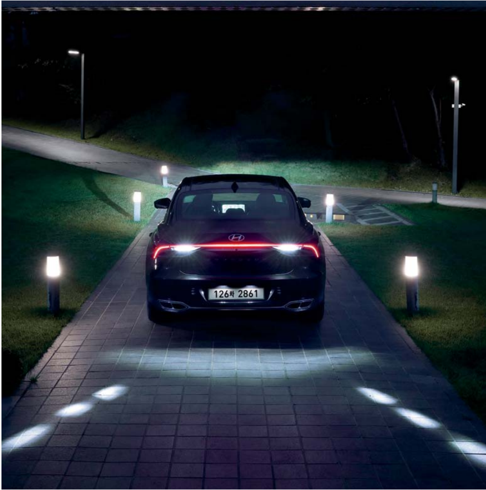
후진 가이드 램프 차량 후진 시 후방 노면에 가이드라인 조명을 투사하여 후진 의도를 효과적으로 전달하며 주변 차량뿐만 아니라 보행자에 대한 사고 위험을 최소화합니다.
