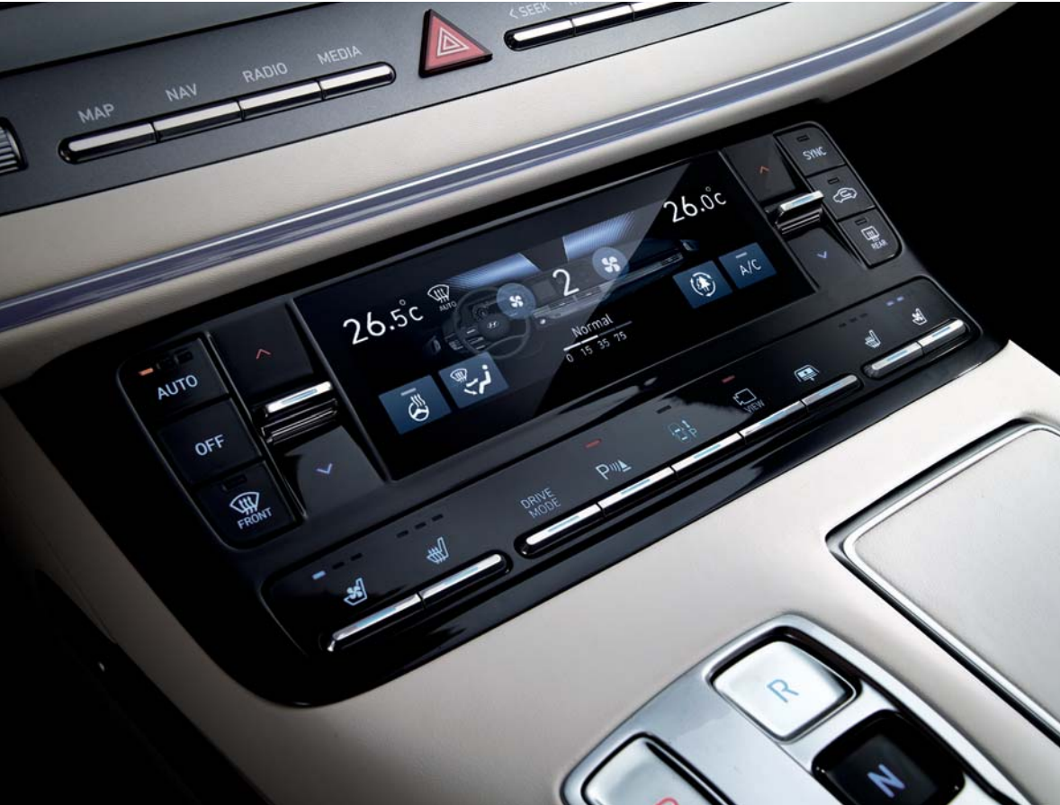
공기 청정 시스템 (듀얼 폴로트 에어컨 / 터치식 공조 컨트롤러 적용) 미세먼지 센서를 통해 차량 내부의 공기질을 실시간으로 모니터링하여 실내 공기질의 상태를 표시해 줍니다. 실내 미세먼지 농도가 높아지면 자동 공기 정화 기능이 작동하여 언제나 쾌적한 실내 환경을 제공합니다.
