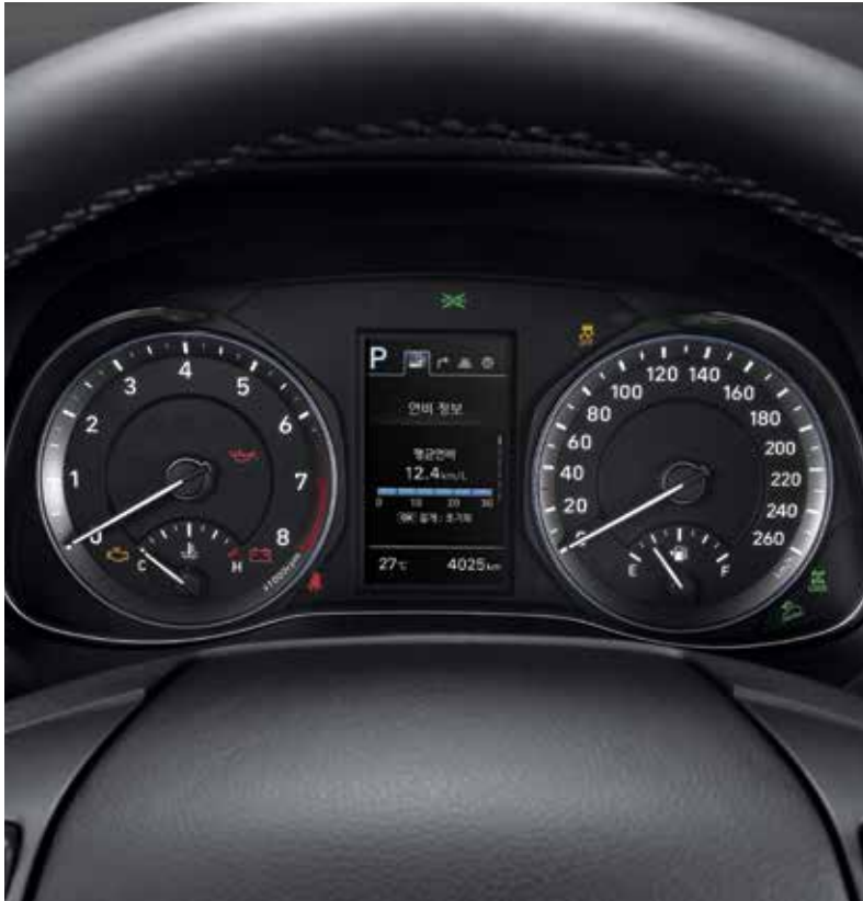
4.2인치 컬러 LCD 클러스터 운전 중 주요 정보를 보다 쉽고 빠르게 인지할 수 있도록, 다양한 정보를 컬러이미지로 전달하는 컬러 TFT LCD 클러스터를 적용하였습니다.
