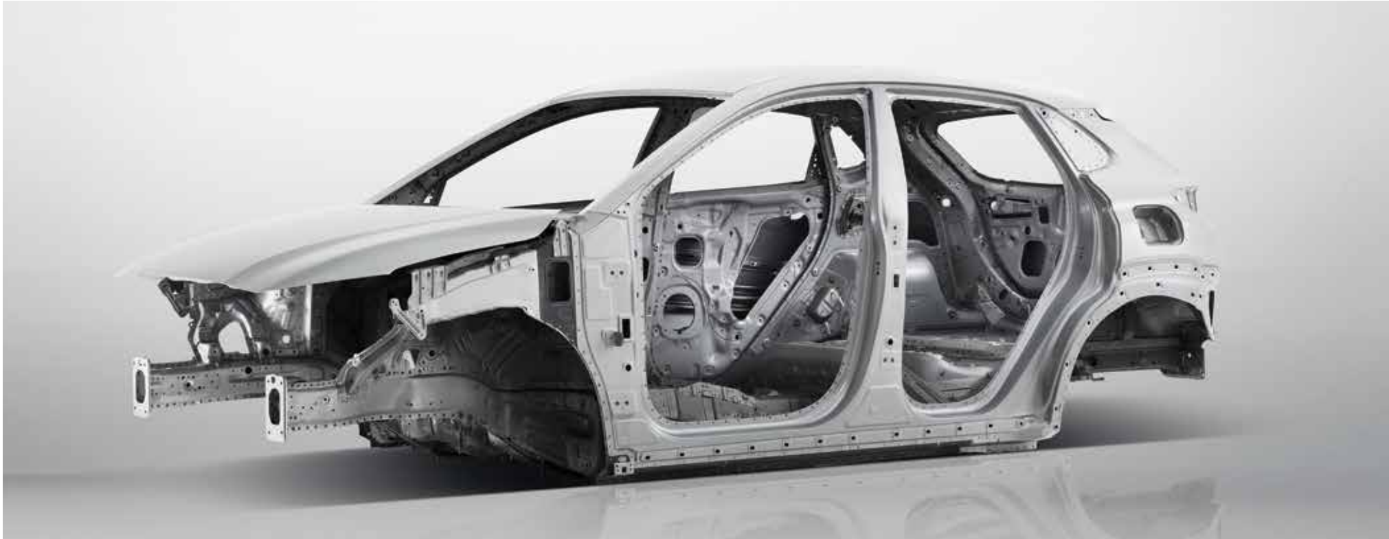
평균 강도 : 65kgf/mm 2 초고장력강 확대 적용으로 차체 평균 강도 향상을 통한 승객 및 주행 안전성을 강화하였습니다.
