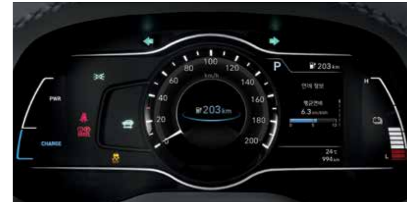
컴바이너 타입 헤드업 디스플레이 7인치 컬러 LCD 버추얼 클러스터
