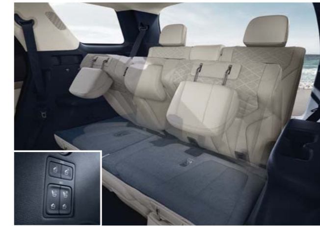
3열 파워 폴딩시트 / 2열 스마트 윈터치 폴딩 러그지 사이트에 있는 버튼으로 3열 시트를 접었다 펼 수 있으며, 2열 시트도 조작할 수 있어 화물 적재시나 3열 이용시 사용자의 편의성을 높였습니다.
