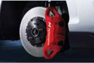
브레이크 시스템 (모노블록 4피스톤 캘리퍼, 대구경 디스크, 로우 스틸 패드)
