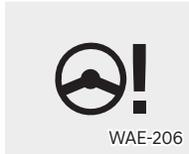
시동을 「ON」으로 하거나 전동 파워 스티어링 (MDPS)이 고장일 경우 경고등이 켜집니다. 주행중 경고등이 켜질 경우 전동 파워 스티어링 시스템에 문제가 예상되므로 자사 직영 서비스센터에서 점검 및 정비를 받으십시오. 전동 파워 스티어링 경고등은 차량에 문제가 없더라도 시동 「ON」 상태에서 약 3초 동안 켜졌다가 꺼집니다.
