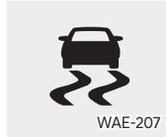
시동 「ON」 상태에서 표시등이 켜지고, ESC 장치에 이상이 없으면 약 3초 후 꺼집니다. 운전중 ESC가 작동할 때는 작동하는 동안 깜빡입니다. 단, 작동 표시등이 꺼지지 않고 계속 켜지거나 주행 중 켜질 경우 ESC 장치에 이상이 생긴 것이므로 가까운 자사 직영 서비스센터에서 점검 및 정비를 받으십시오. 자세한 내용은 5장 「차체 자세 제어장치(ESC)」을 참고하십시오.
