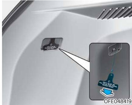
배터리의 방전 및 차량의 전기 배선 이상으로 인해 연료충전구 커버가 열리지 않는 경우, 테일게이트를 열고 비상용 고리를 화살표 방향으로 가볍게 당기면 연료충전구 커버가 열립니다.
