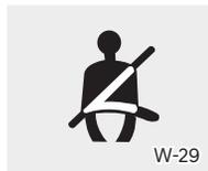
운전석의 안전벨트를 착용하지 않은 상태에서 시동 「ON」 하면, 경고등이 켜져 안전벨트를 착용하지 않았음을 알려줍니다. 시속이 9 km/h 가 넘어가면 경고등이 깜빡이며, 20 km/h 이상 시에는 경고등이 깜빡이고 경고음이 울리면서 안전벨트를 착용하지 않았음을 알려줍니다.
