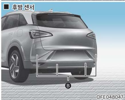
※ A: 전방 센서, B: 후방 센서
