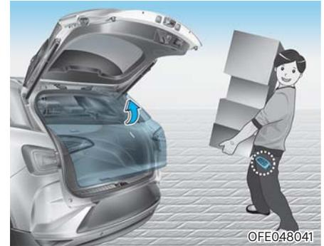
스마트키 차량에서 간단한 설정으로 테일게이트를 자동으로 열리도록 하는 장치로, 양손에 짐을 휴대한 경우 편리하게 이용할 수 있습니다.
