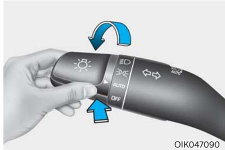
하이빔 보조(HBA) 시스템은 전조등을 자동으로 상향 및 하향으로 전환하는 편의 장치입니다. 앞유리 상단에 장착된 전방 카메라를 이용하여 야간에 마주오는 차량 또는 선행 차량의 램프 및 주변 밝기 상태를 감지하여 전조등을 자동으로 상향 또는 하향으로 전환합니다.
