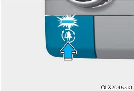
공기 정화 모드 버튼을 누르면 오염된 외부 공기를 차단하고, 실내 공기를 순환시켜 쾌적한 실내 공기를 제공합니다. 5분간 작동 후 이전 설정된 모드로 변경됩니다.
