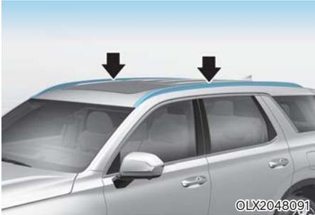
루프랙을 이용하여 차량 위에 짐을 실을 수 있습니다. 화물적재를 위한 보조기구(캐리어 등) 장착시 차량 상태 및 안전을 고려하여 장착하십시오. 특히 선루프 장착 차량은 선루프 작동을 방해할 수 있는 위치를 피하여 장착하십시오.
