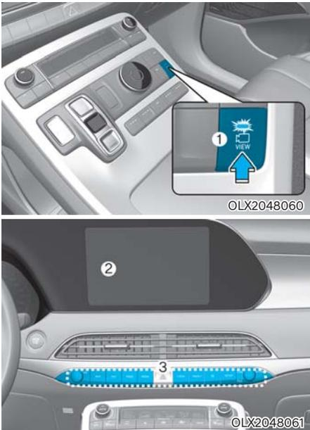
주행 중에 차량의 속도와 관계없이 차량 후방 영상을 모니터로 확인하여 주행을 보다 안전하게 할 수 있도록 도와주는 주행 지원 시스템입니다.
