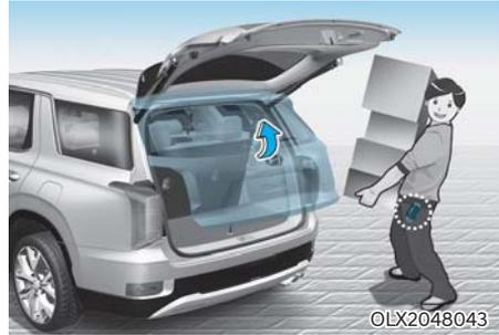
스마트키 차량에서 간단한 설정으로 테일게이트를 자동으로 열리도록 하는 장치로, 양손에 짐을 휴대한 경우 편리하게 이용할 수 있습니다.
