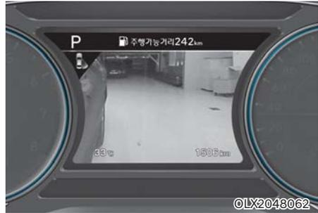
차량에 장착된 광각 카메라를 이용해 운전자가 방향지시등을 켜는 쪽의 후측방영상을 계기판에 띄워 주는 기능입니다. 운전자가 고개를 돌리거나 시선을 크게 옮기는 수고를 덜어주며, 아웃 사이드 미러 대비 광각의 영상 제공을 통해 더 넓은 시야를 확보하여 더 안전한 운전을 도와주는 기능입니다.
