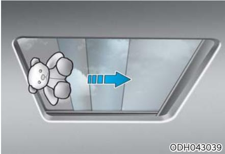
햇빛 차단용 블라인드 또는 선루프가 슬라이딩 되면서 닫히는 중에 일정한 힘이 감지되면 자동으로 작동을 멈추고, 일정 위치만큼 다시 열립니다. 그러나, 감지된 저항이 일정한 힘 이하일 경우에는 끼임 인식 기능이 작동되지 않습니다. 안전을 위해 작동할 때는 손이나 머리 등 신체의 일부 또는 기타 장애물이 없는지 확인 후 작동하십시오.
