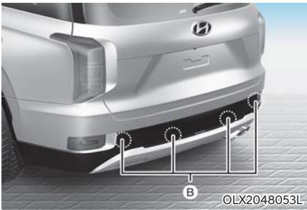
※ [A]: 전방 센서, [B]: 후방 센서
