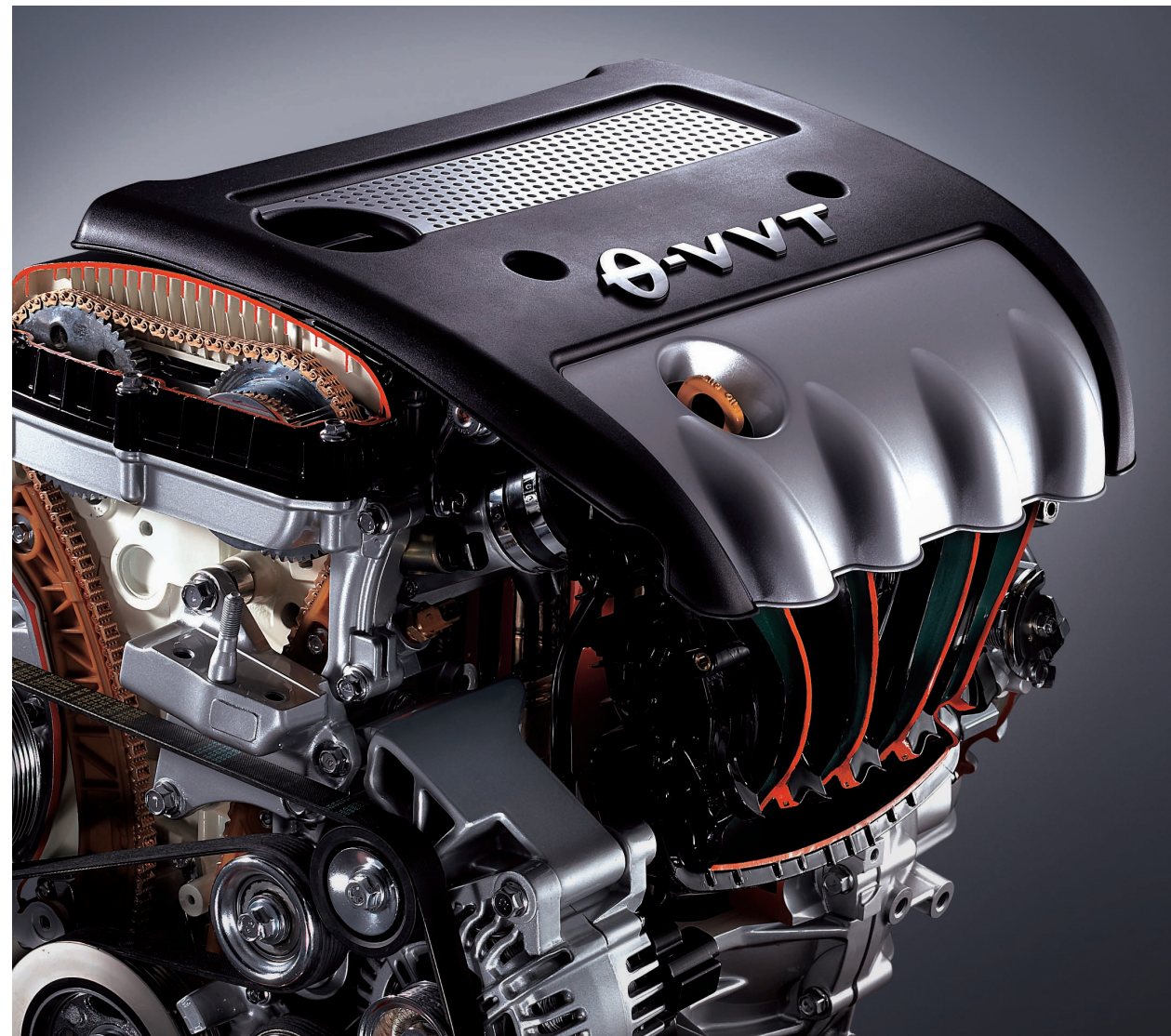
▲ 세타 엔진은 현대자동차가 독자적으로 설계한 고성능 엔진으로서 다임러크라이슬러와 미쓰비시에 기술을 이전, 그 성능과 기술수준을 인정받고 있다.
