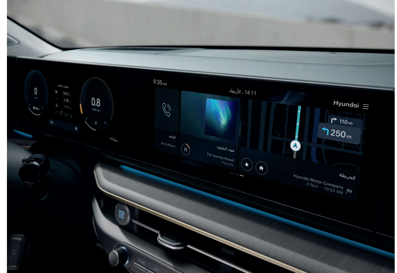
نظام المعلومات والترفيه CCNC (وحدة قيادة ملاحية متصلة بالسيارة)
