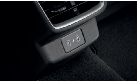
منافذ USB من النوع C للمقاعد الخلفية (٢ مدخل)
