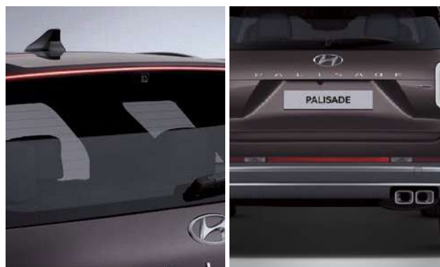
Дополнительный светодиодный стоп-сигнал и защитные пластины в задней части кузова
