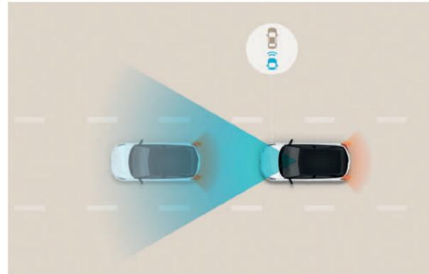
**Система автоматического торможения перед препятствием спереди (FCA)**
