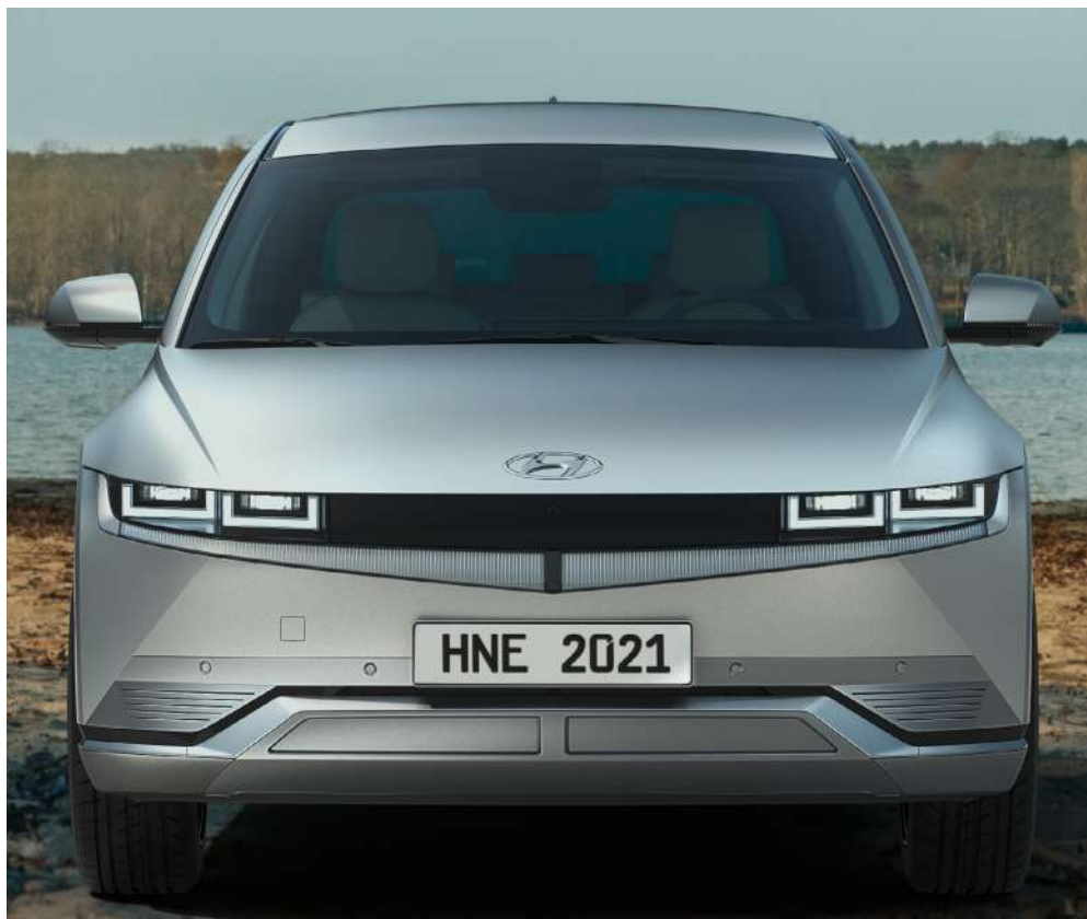
Передний бампер с активными воздухозаборниками.
