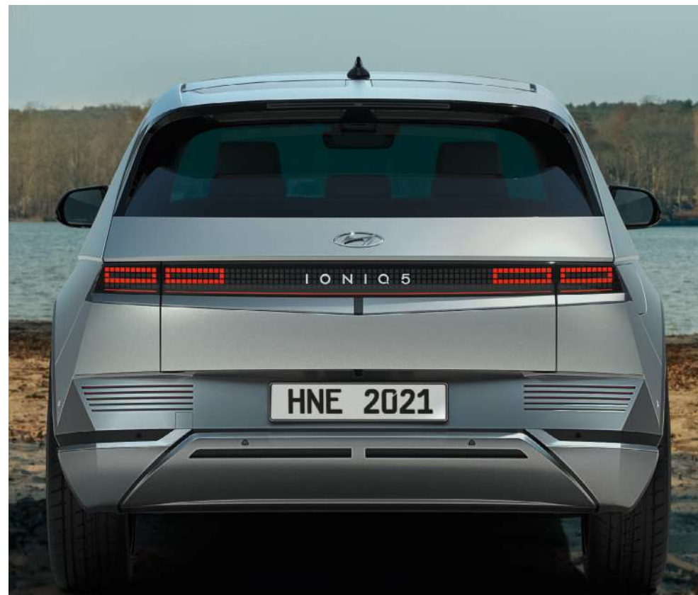
Задние фонари со световым рисунком «параметрические пиксели».
