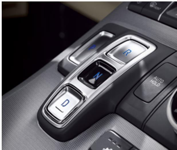
Переключение режимов 8-ступенчатой автоматической коробки передач кнопками
