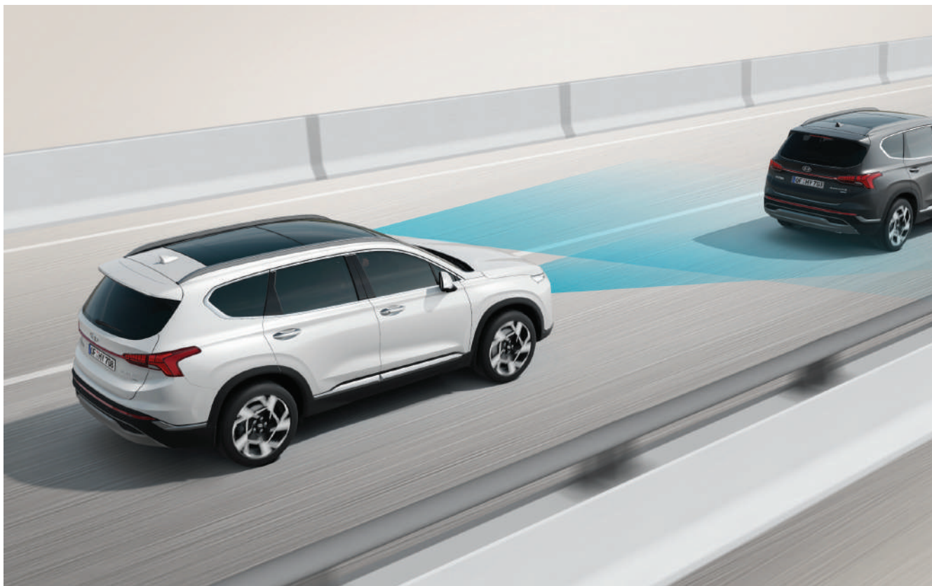
Көлік кептелісінде қозғалыс көмекшісі бар интеллектуалды круиз-бақылау (SCC). Алда келе жатқан көлік құралына дейін берілген жылдамдық пен қашықтықты сақтайды. Қысқа уақытқа тоқтаған кезде қозғалысты автоматты түрде қайта бастайды.
