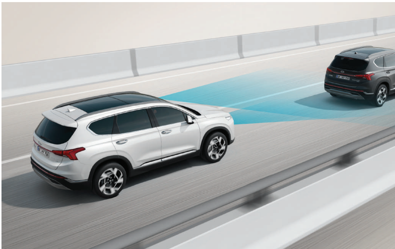
Интеллектуальный круиз-контроль с ассистентом движения в пробке (SCC). Поддерживает заданные скорость и дистанцию, до впереди идущего транспортного средства. При кратковременной остановке возобновит движение автоматически.
