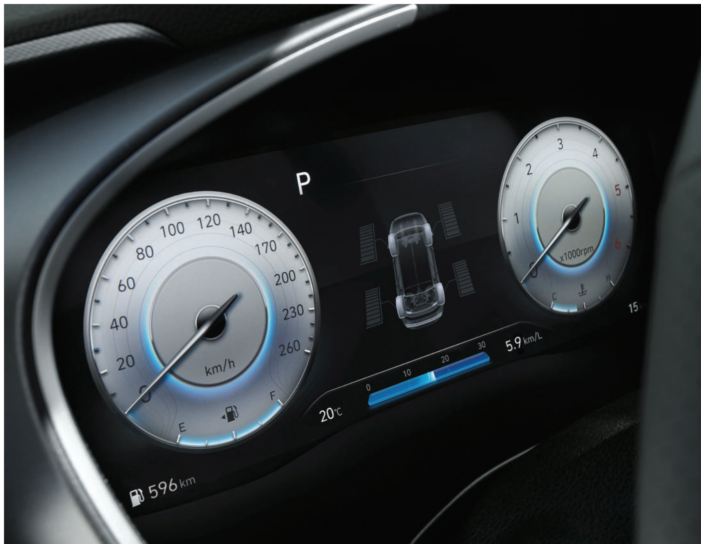
Полностью цифровая комбинация приборов диагональю 12,3 дюйма.
