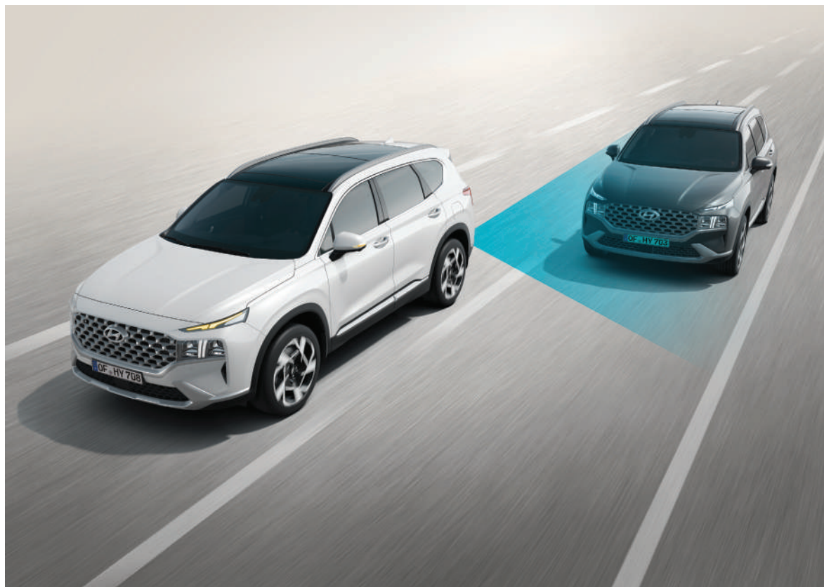
Система предотвращения столкновений в «слепых» зонах (BSA).
