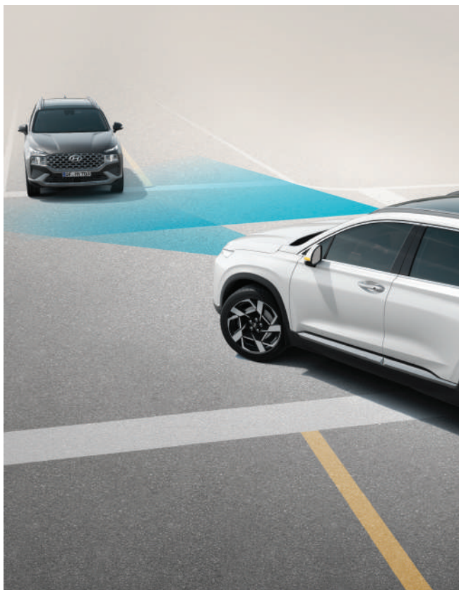
Система предотвращения фронтальных столкновений (FCA с функцией помощи при проезде перекрестка).
