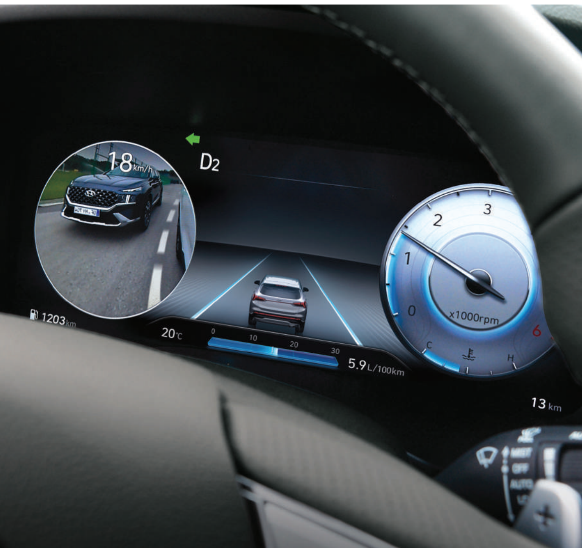
12,3-дюймовая полностью цифровая комбинация приборов и монитор «слепых» зон.
