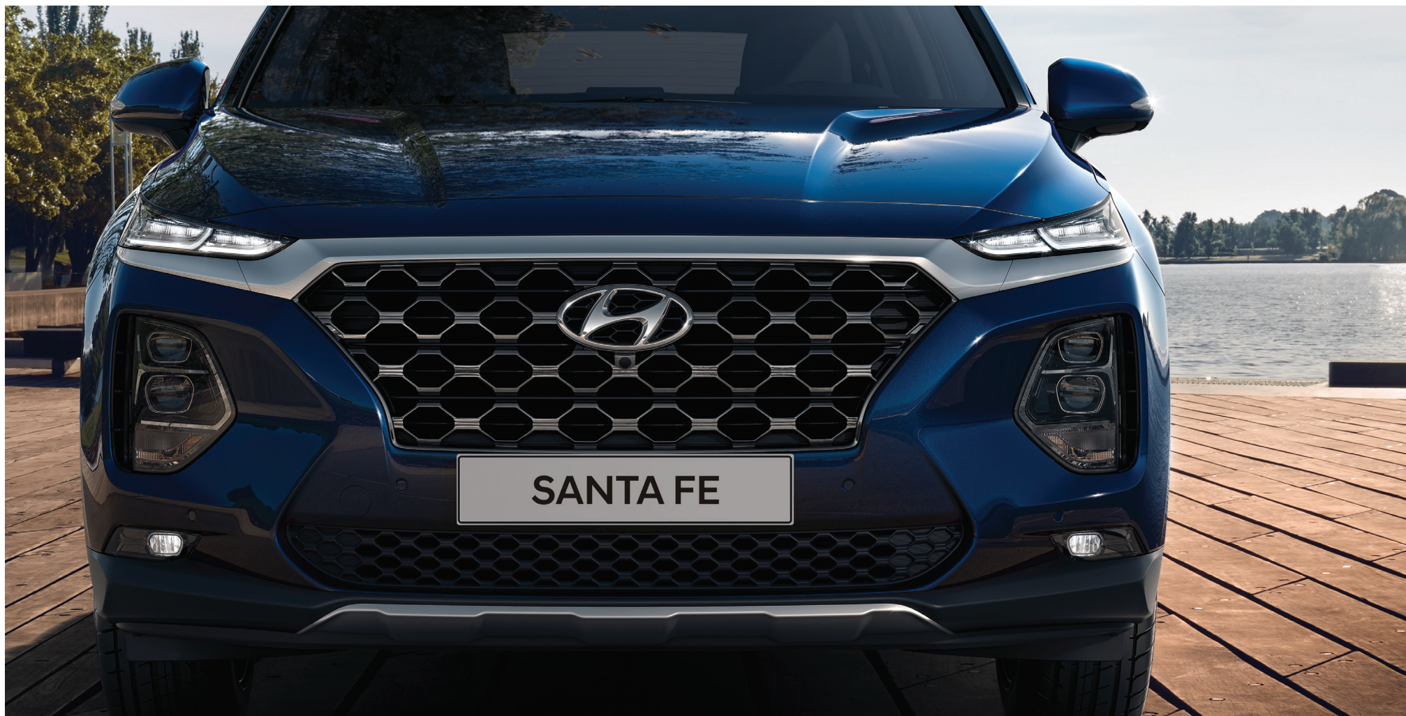
Радиатор торы / жарық диодты күндізгі жарық фаралары (КЖФ) / жарық диодты фаралар / жарық диодты тұманға қарсы фаралар
