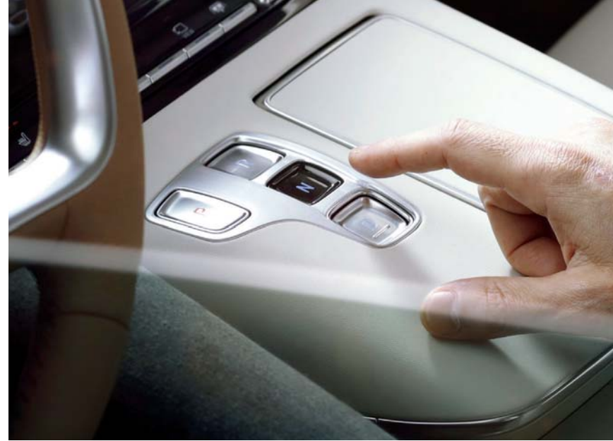
ناقل حركة أوتوماتيكي مزود بتقنية التحكم بنقل الحركة "شيفت باي واير"
