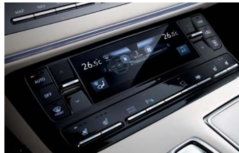
لوحة تحكم في المناخ بشاشة لمس (أزرار تلقائية مزدوجة للتحكم في مكيف الهواء)
