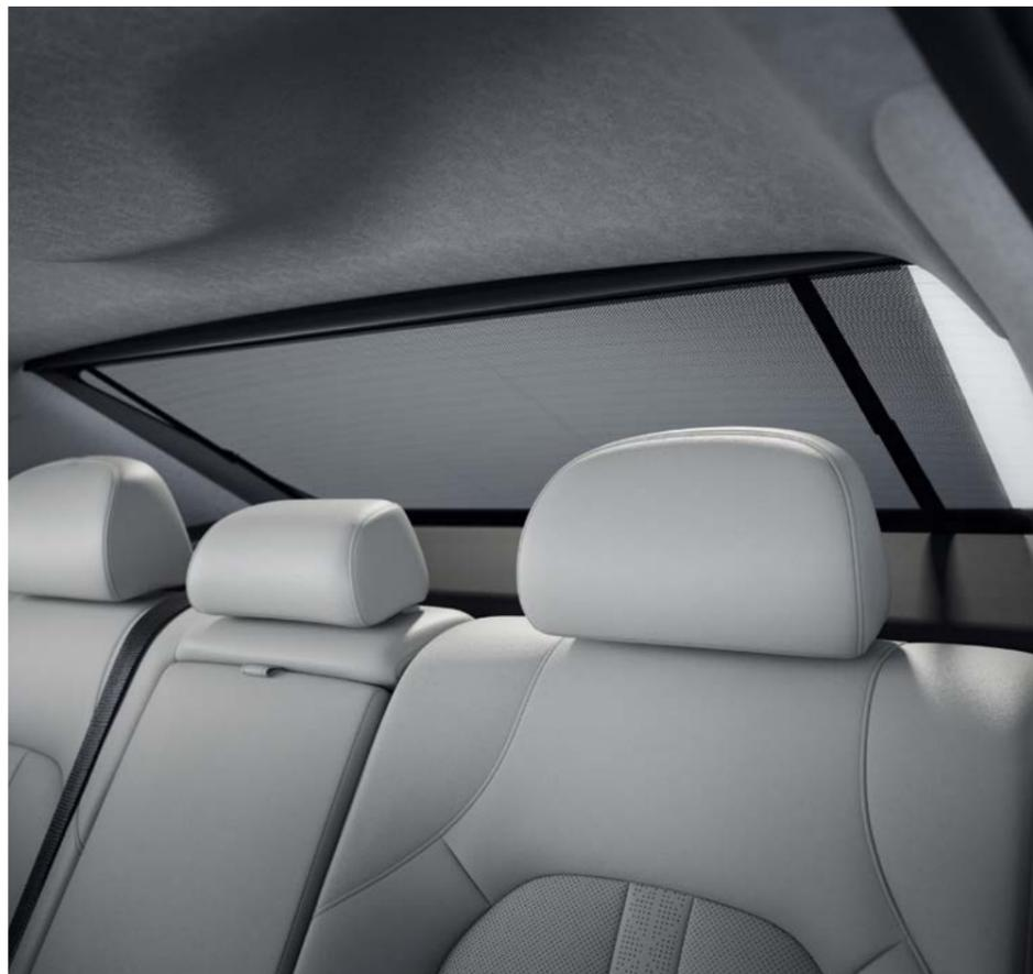
ستارة تظليل النافذة الخلفية تعمل بالكهرباء
