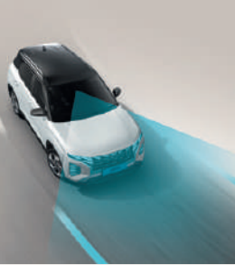
Lane Following Assist (LFA)* ระบบควบคุมรถให้อยู่กลางเลน
