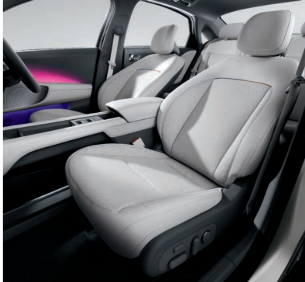
Front relaxation comfort seats เบาะที่นั่งด้านคนขับและผู้โดยสารด้านหน้าสามารถปรับเอนนอนแบบ Relaxation Seats ด้วยไฟฟ้า และระบบปรับเบาะอุ่น/เย็น เพื่อความผ่อนคลายและสะดวกสบาย
