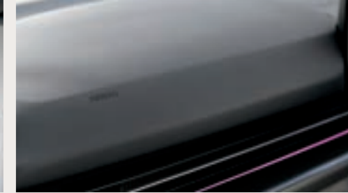
BIO-TPO crash pad วัสดุที่ใช้สำหรับแผงกันกระแทก (crash pad) ผลิตจากเส้นใยธรรมชาติที่ทำจากอ้อย ซึ่งเป็นมิตรต่อสิ่งแวดล้อม
