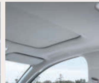
BIO-PET yarn headlining เพดานใช้วัสดุเส้นใย BIO-PET ที่สกัดและรีไซเคิลจากอ้อย เป็นมิตรกับสิ่งแวดล้อม
