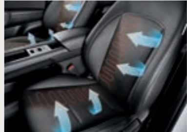
เบาะคู่หน้าสามารถปรับอุณหภูมิได้ ทั้งระบายความร้อนและให้ความอบอุ่น
