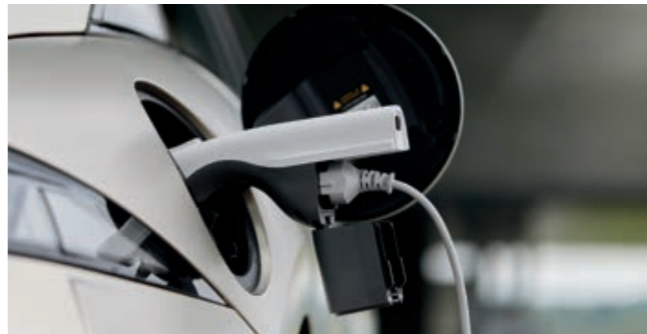
Vehicle-to-Load (V2L) นวัตกรรม V2L ช่วยให้คุณสามารถเชื่อมต่อเครื่องใช้ไฟฟ้าทั่วไป เข้ากับเต้ารับไฟฟ้าทั้งภายในและภายนอกตัวรถ เต้ารับรองรับไฟฟ้ากระแสสลับ 220V โดยให้กำลังไฟสูงสุด 3.6 กิโลวัตต์ (สำหรับอุปกรณ์ 220V)
